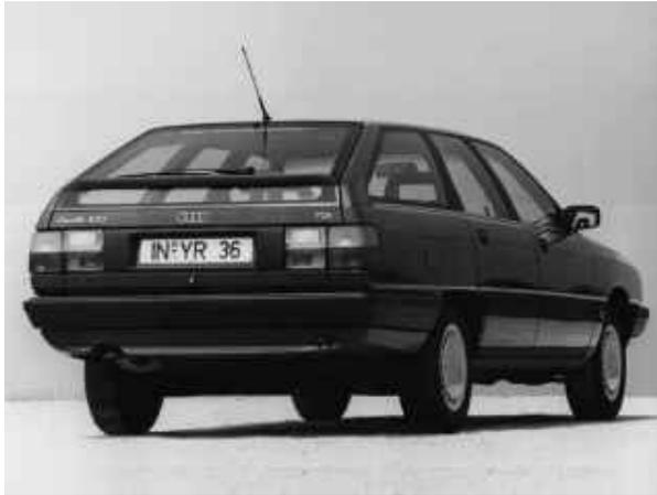
En 1990, se exhibió por primera vez en el Motor Show de Ginebra el Audi Duo, en un Audi 100 Avant quattro con motor frontal convencional, pero con un motor eléctrico integrado en la transmisión trasera, pudiéndose utilizar uno u otro según las circunstancias.
