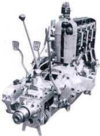
En 1931, DKW comercializó el F1, el primer auto con tracción delantera fabricado en serie. Anteriormente los autos contaban con tracción trasera, Audi introduce el sistema de tracción delantera basado en el principio de que es más fácil jalar algo que empujarlo.
