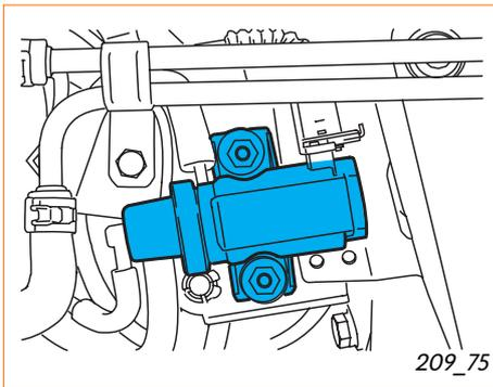
El motor tiene un turbocompresor variable, con objeto de adaptar de forma óptima la presión de sobrealimentación a las condiciones momentáneas de la marcha. La unidad de control del motor se encarga de excitar la electroválvula para limitación de la presión de sobrealimentación.
