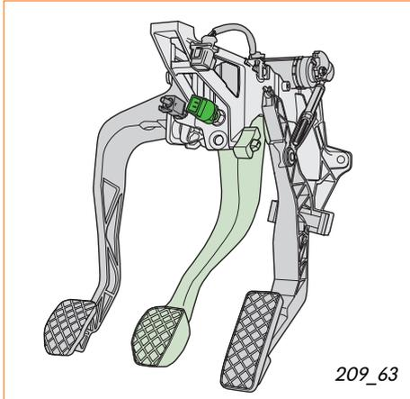
El conmutador de luz de freno y el conmutador de pedal de freno están agrupados en un componente compartido, en el pedalier.
