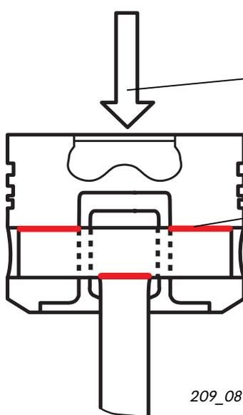
En comparación con la unión convencional entre el pistón y la biela, con la geometría trapecial aumenta la superficie de apoyo entre el ojo de la biela y el cubo del pistón en la zona del bulón.
