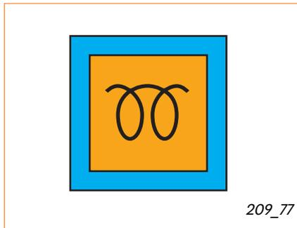
El testigo luminoso de precalentamiento se halla en el cuadro de instrumentos.
