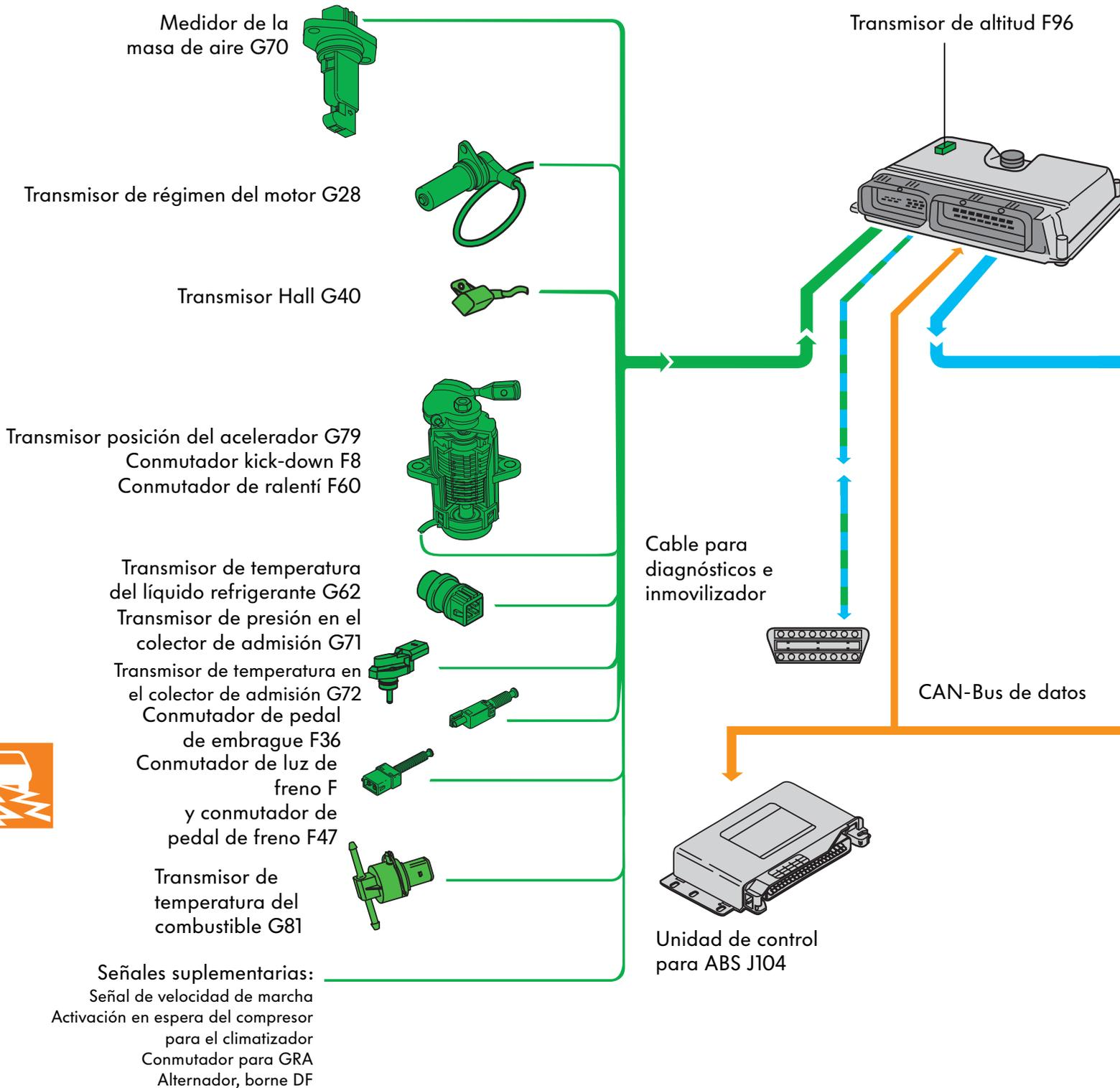
Unidad de control para sistema de inyección directa diesel J248
