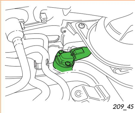
El transmisor de presión en el colector de admisión y el transmisor de temperatura en el colector de admisión están agrupados en un solo componente, en el conducto de admisión.
