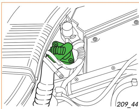
El medidor de la masa de aire con detección de reflujo calcula la masa de aire aspirada. Está instalado en el conducto de admisión.
