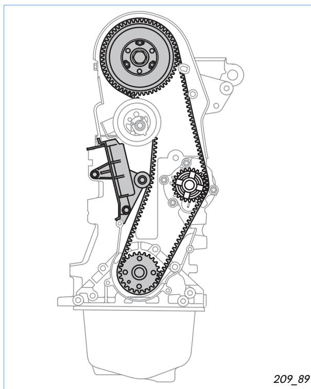
Para someter a la correa a menores cargas durante el ciclo de la inyección, la polea dentada del cigüeñal tiene dos parejas de dientes con un entrediente más grande que los dientes restantes.
