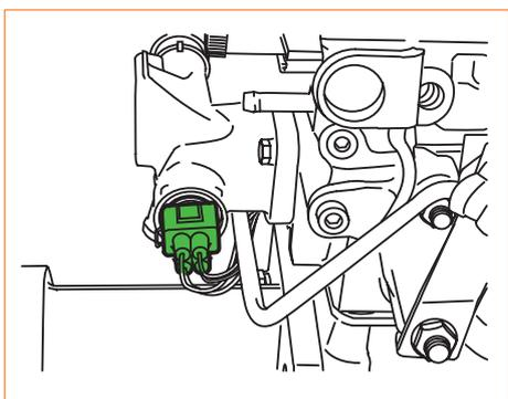
El transmisor de temperatura del líquido refrigerante se encuentra en el empalme de la culata para el paso de líquido refrigerante. Informa a la unidad de control del motor acerca de la temperatura momentánea del líquido refrigerante.
