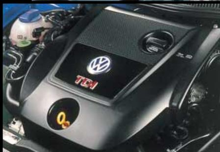
El motor de cuatro cilindros en línea e inyección directa tiene una tapa superior a modo de insonorizante que lo oculta casi al completo.
