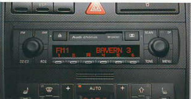
**Equipo Radio Chorus II:** reproductor de cassettes, memoria para 12 emisoras, gama de sintonización FM (onda ultracorta) y AM (onda media, onda larga), mando softkey y display en dos partes, mando del cambiador de CD, 4 altavoces en las puertas delanteras, 2 altavoces de dos vías detrás, así como una caja de refuerzo de bajos
