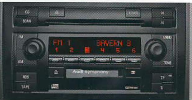
**Equipo Radio Symphony II:** igual que Radio Chorus, pero además del reproductor de cassettes incluye un cambiador integrado para 6 CD y antena "diversity" de recepción cuadruple (altura de montaje doble)
