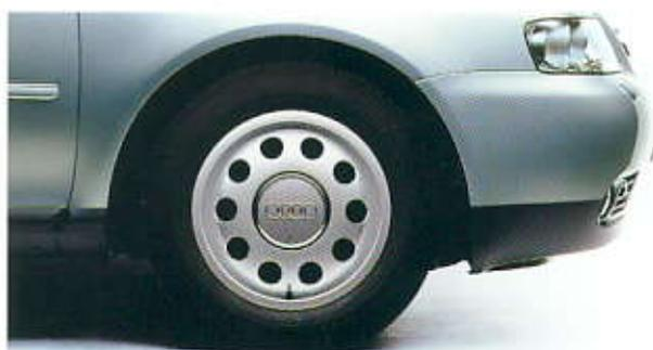
**Llantas de aluminio** en diseño de 10 orificios, tamaño 6 J x 15 con neumáticos 195/65 R15 (exclusivo en modelos Attraction); disponible opcionalmente con neumáticos anchos 205/60 R 15 V
