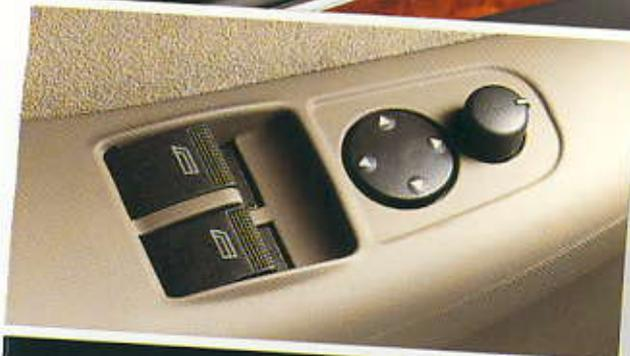
**Elevalunas**, delantero, eléctrico (en los 5 puertas también detrás), con limitación de fuerza, con dispositivo de apertura por contacto en todas las ventanilla y de cierre por contacto en las delanteras; cierre y apertura de confort mediante cierre centralizado
