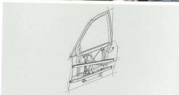
**Barras laterales de seguridad en las puertas:** soporte de choque de aluminio resistente a la flexión y la torsión, refuerzo de construcción en bruto de los pilares B; acolchados de protec. lateral de gran tamaño en las puertas del. de espuma plástica absorbente de energía en la zona abdominal
