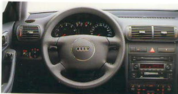
**Volante** con airbag de gran tamaño, en diseño de cuatro radios, acolchado, regulable en altura y distancia (en España, con volante de cuero de serie)
