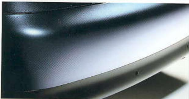
**Parachoques**, revestidos de material plástico, en el color de la carrocería, pintados en la parte inferior en color gris oscuro
