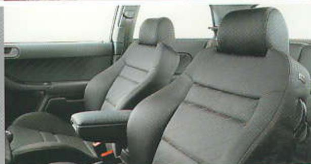
**Asientos deportivos Recaro:** laterales de los asientos especialmente realzados y apoyo de los muslos regulable manualmente; altura del asiento, inclinación del respaldo y apoyo lumbar regulables eléctricamente
