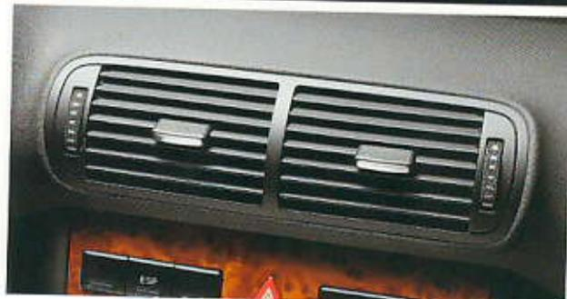
**Sistema de ventilación:** cuatro salidas de aire de regulación independiente en el cuadro de mandos se encargan de alcanzar una buena ventilación; la rueda de ajuste se ilumina con las luces del vehículo encendidas; embellecedores de aluminio en el mando de orientación
