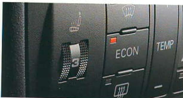
**Calefacción de asientos** para asientos del conductor y el acompañante, calienta la superficie de los asientos, los respaldos y laterales, y es regulable individualmente en 6 niveles; especialmente confortable en invierno para el tapizado en cuero
