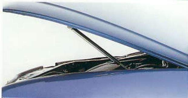
**Amortiguador a presión de gas** para el capó del motor; 2 para el portón del maletero con inmovilización intermedia
