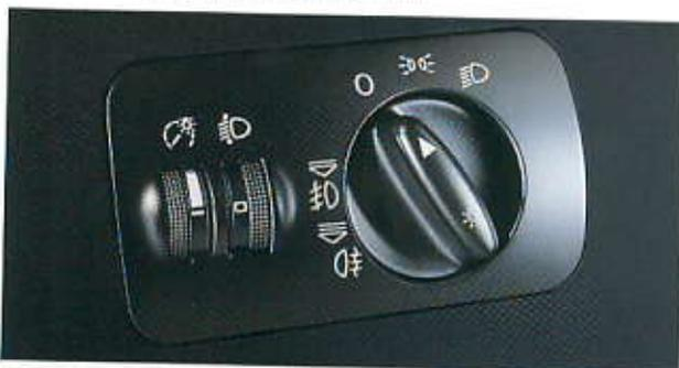
**Unidad de conmutación de luces** para las luces de posición y de cruce, así como para los faros antiniebla y el piloto antiniebla trasero; regulación eléctrica del alcance de las luces
