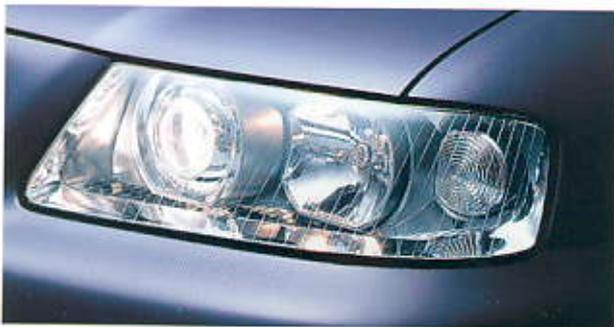
**Faros:** faro principal elipsoidal de una sola pieza con cristal de recubrimiento transparente, regulación eléctrica del alcance luminoso
