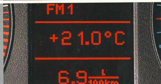
**Sistema de información del conductor FIS** con pantalla para: Auto-Check-Control, frecuencia de radio (sólo con radio Audi), 2 avisadores regul. de vel., temperatura ext., ordenador de a bordo, puertas y maletero mal cerrados, niveles de marcha (tiptronic), servicios periódicos (de serie en A3 1.8 T 180 CV)
