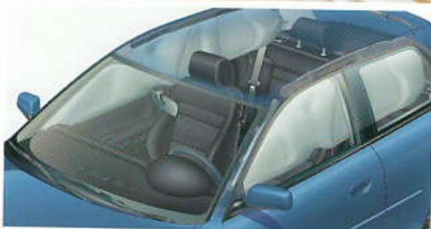
**SIDEGUARD:** airbag lateral para cabeza, protege a pasajeros anteriores y post. en colisión lateral; se despliega como una cortina frente a la superficie de las ventanillas laterales; complementa a las **barras de protección lateral** en las puertas y a los airbags laterales integrados en respaldo de asientos
