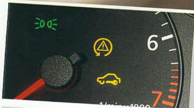
**Inmovilizador de marcha**, electrónico, integrado en el dispositivo de control del motor; activación automática mediante la llave del vehículo
