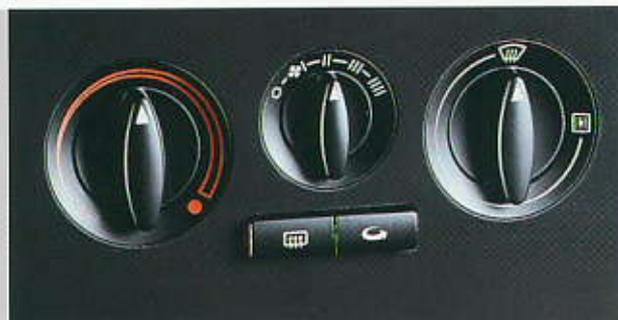
**Climatizador**, sin CFC, con regulación dependiente de la posición del sol; regula electrónicamente la temperatura, la cantidad y la distribución del aire; dispone de accionamiento manual, identificación de llave, filtro de polvo y polen con carbón activo
