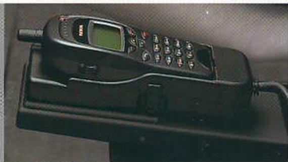
**Teléfono fijo GSM**, Nokia 6010, en la consola central (en caso de apoyabrazos central delantero, integrado en el compartimento portaobjetos), incluye dispositivo manos libres, recepción autom. de llamadas y silenciador de radio; conexión para fax y portátil
