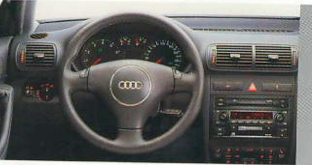
**Volante deportivo en cuero** con mando para tiptronic y airbag de gran tamaño, en diseño de 3 radios, incluye pomo y guarnición de la palanca de cambios en cuero (exclusivo para Ambition)
