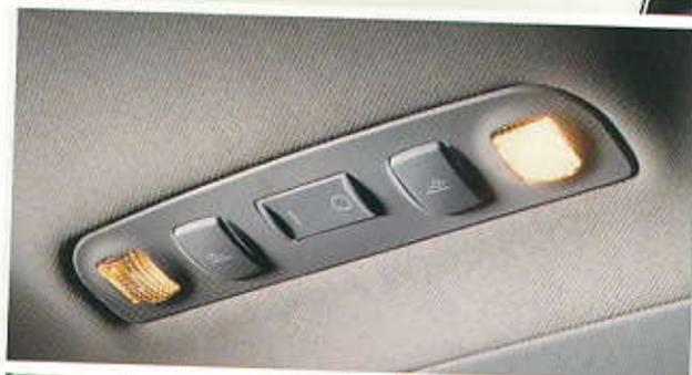
**Iluminación interior**; luces de superficie delante y detrás con desconexión retardada, y dos luces de lectura, iluminación del maletero
