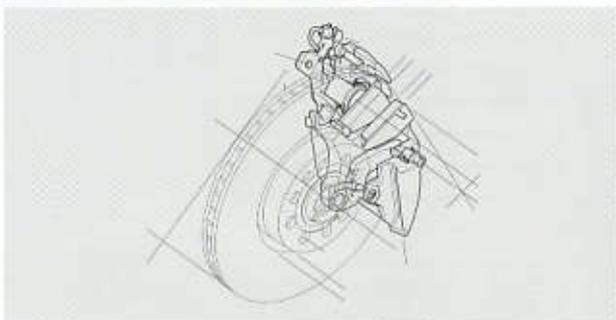
**Sistema de frenos con sistema antibloqueo ABS y distribución electrónica de la fuerza de frenado EBV**, frenos de disco delante y detrás (delante autoventilados)
