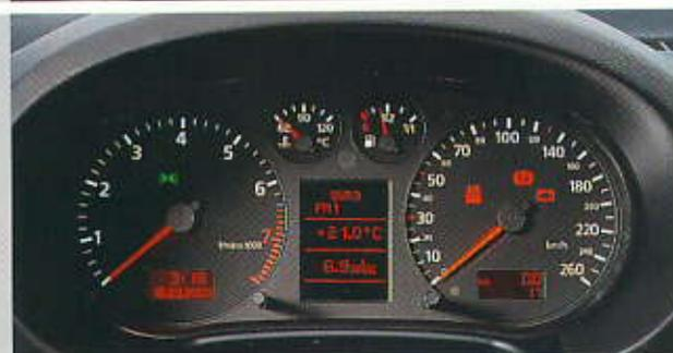
**Indicador de temperatura exterior:** con temperaturas inferiores a +5 °C el indicador de temperatura exterior advierte de la posible formación de hielo mediante el símbolo de un cristal de hielo en el campo de indicadores (incluido en el sistema de información al conductor FIS)
