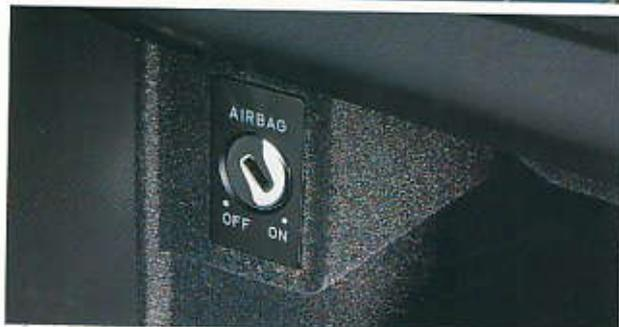
**Interruptor de desactivación del airbag:** mediante un interruptor de llave alojado en la guantera puede desactivarse el airbag del lado del acompañante, p. ej. cuando instale una silla para niño
