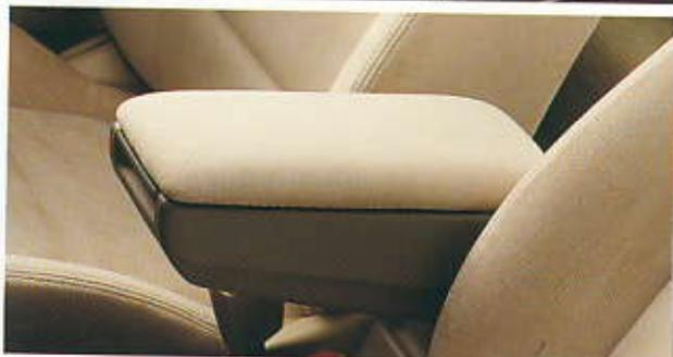
**Apoyabrazos central delantero** para conductor y acompañante, con bandeja portaobjetos, de inclinación regulable (de serie en Ambiente)
