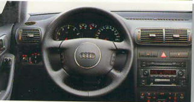
**Volante multifuncional en cuero** con airbag de gran tamaño, en diseño de 4 radios, incluye pomo y guarnición de la palanca de cambios en cuero; para el mando del equipo de radio Audi y el teléfono fijo Audi; opcionalmente con mando para tiptronic
