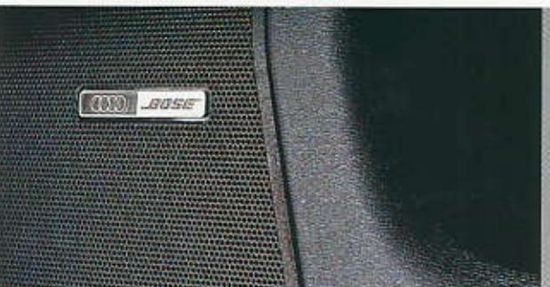
**Sistema de sonido BOSE:** 6 altavoces de alta potencia más caja de refuerzo de bajos, amplificador de 5 canales con una potencia total de 220 vatios; el sistema se adapta de manera exacta a la acústica del habitáculo
