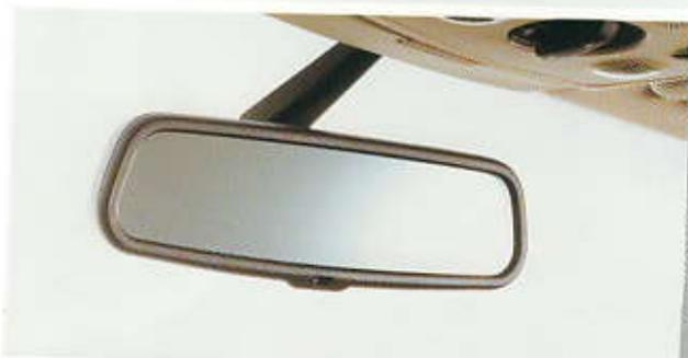
**Retrovisor interior con regulación antideslumbramiento automática.** Con ayuda de una fotocélula reconoce la luz demasiado intensa desde atrás y se oscurece automáticamente; también disponible en combinación con retrovisores exteriores antideslumbrantes y térmicos
