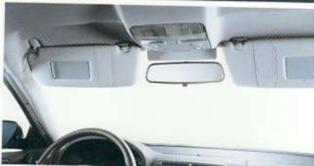
**Parasoles**, abatibles y orientables, con espejos de cortesía iluminados en el lado del conductor y del acompañante, tercer parasol sobre el retrovisor interior
