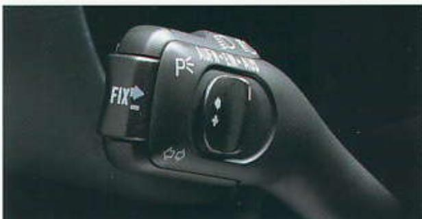
**Sistema de regulación de la velocidad**: electrónico, mantiene constante una velocidad elegida por encima de 40 km/h, siempre que lo permita el rendimiento de la potencia del motor y del frenado, hasta que usted pise el freno, el embrague o el pedal de aceleración, o bien hasta que desconecte el sistema
