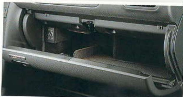
**Ganterera** en el lado del acompañante, con cerradura, con dispositivo de regulación de función de portaobjetos, con iluminación, portamonedas integrado, soporte para bolígrafos y dispositivo de soporte para bebidas
