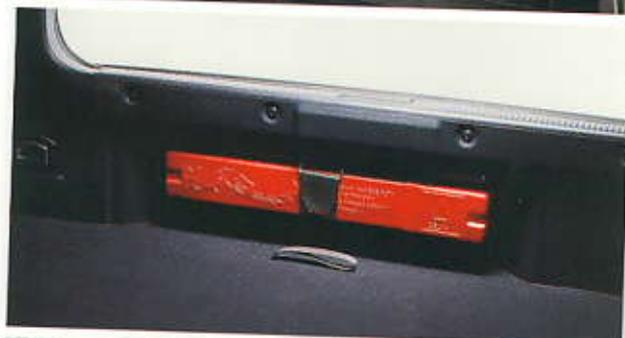
**Triángulo de señalización** en el maletero debajo del recubrimiento de los bordes de carga
