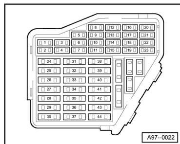
En el esquema de circuitos de corriente, los fusibles en el portafusibles están designados con 223 a partir de la posición 23.
