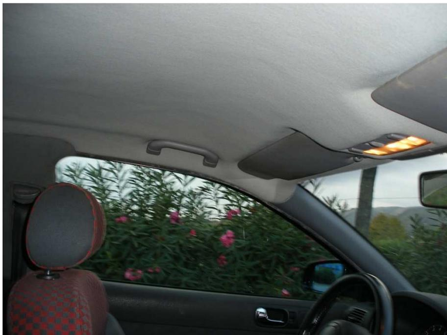
***Las pequeñas ondulaciones que se ven en la foto se destacan artificialmente por el flash y el ángulo de la luz. Realmente no se aprecian al natural y el aspecto del acabado con este material es casi perfecto, como de fábrica.***
