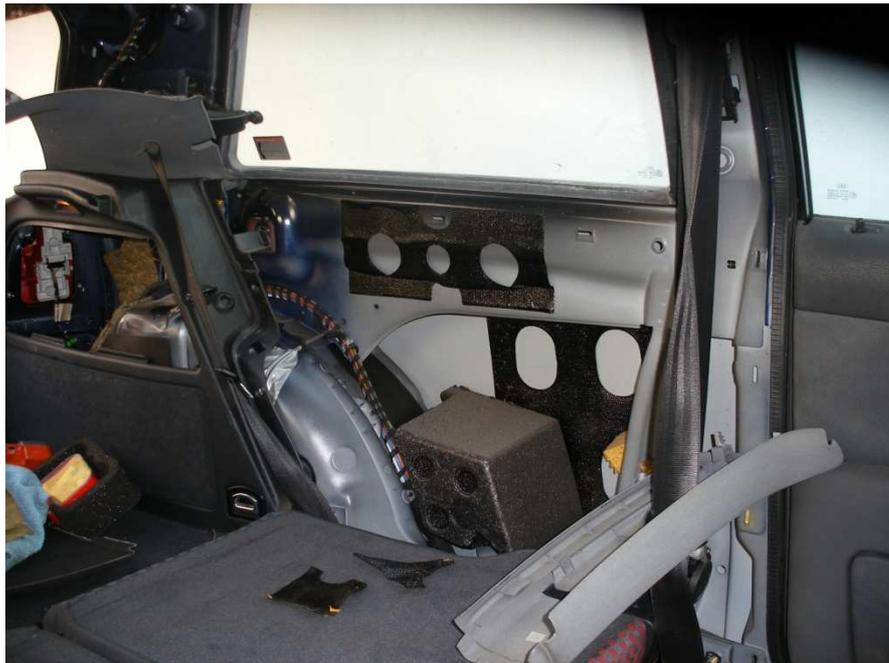
**Desmontar tapeta superior trasera.** Destornillador por el centro y clips
