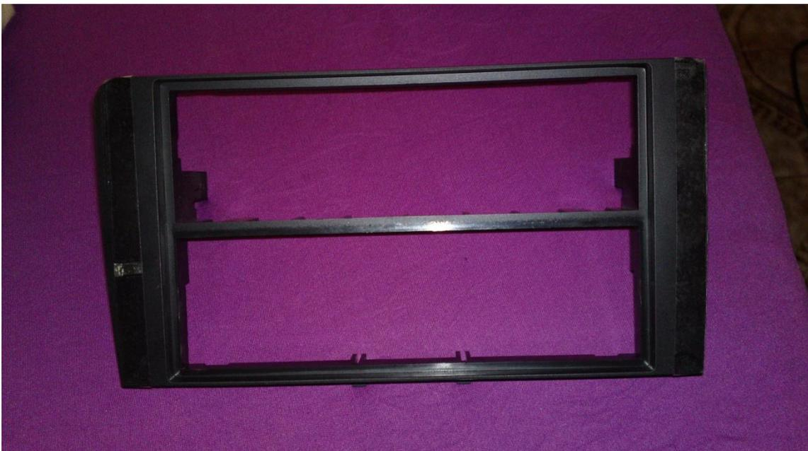
En esta otra foto se ve la cinta y el trozo que tengo que quitar hasta dejarlo a ras de la cinta, una vez rebaje el lateral, cortare la tira central que separa los huecos de 1 din
