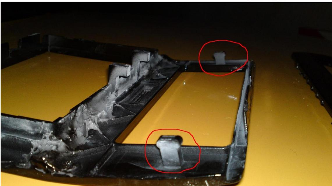
Que encajan en las grapas que lleva el climatizador, que aunque no lo he sujetado con tornillos, por que entra a presion en su hueco, si que he montado las grapas en el clima, con su tornillo cojido por detrás con una tuerca para poder enganchar el embellecedor
