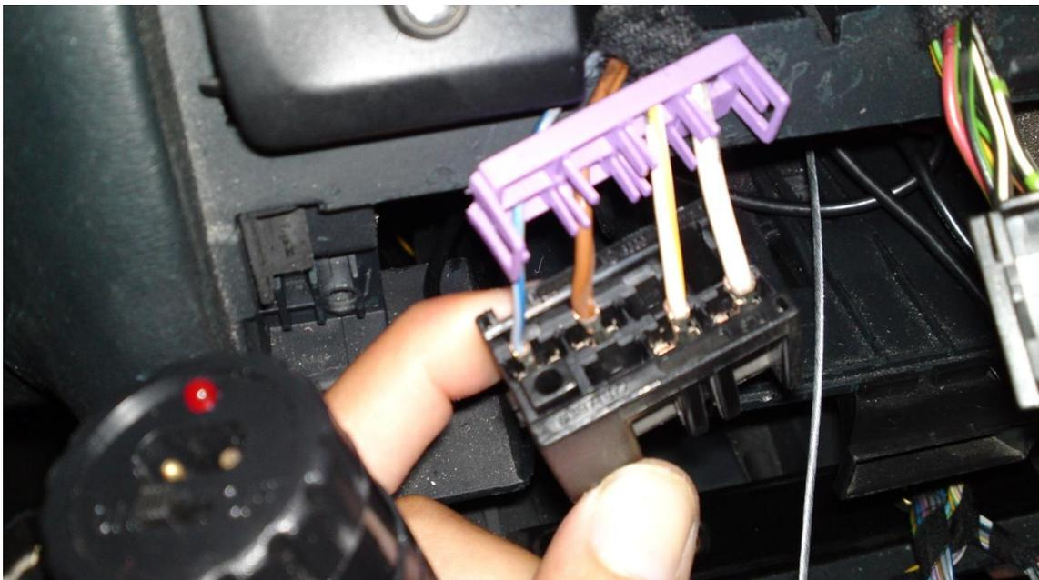
Y ahora por la parte delantera con el destornillador doblamos las pestañas de retención
