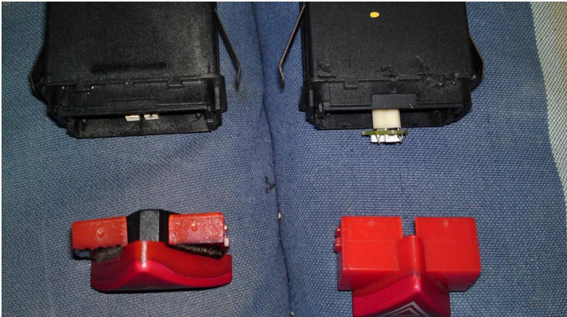
**Solo nos queda la conexión del cenicero, en el pre-restyling el coche lleva dos conectores, uno que alimenta el encendedor, y el otro que alimenta la iluminación del encendedor, pará cuando encendemos las luces...**
