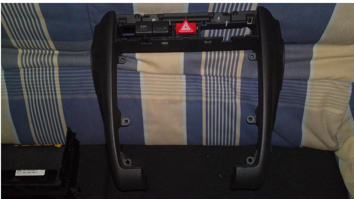
**Se diferencia de la del pre-restyling, por que se desmonta en dos partes, una externa casi idéntica a la del pre-restyling ,excepto la botonera, su alojamiento y la parte baja junto al cenicero, que son diferentes, y otra interna que puede ponerse de 1 din o de 2 din...**
