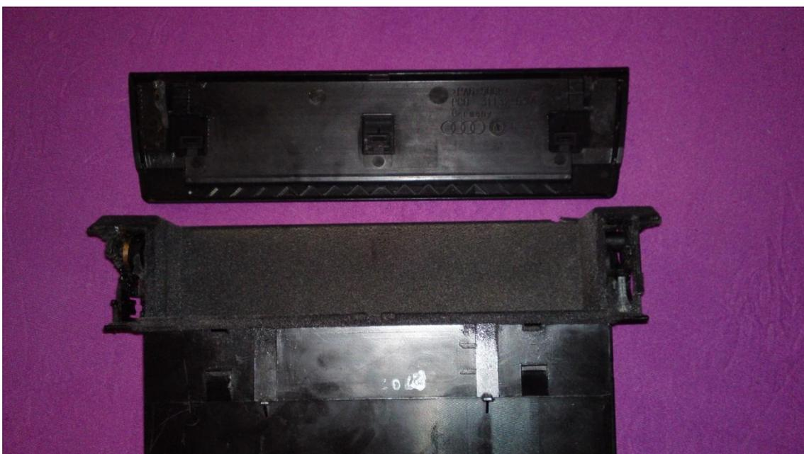
**Ahora vamos a aprovechar las guías que tiene a los lados, y el tope de la parte trasera y la parte superior, con sus pestañas de retención, para crear el soporte para el clima...**
