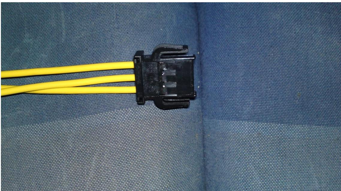
Y aquí otra con el conector ya conectado al encendedor, como he puesto antes el pre-restyling, lleva 2 conectores con 4 cables, entre los dos conectores y el restyling, solo lleva un conector de 3 pines donde van conectados los 4 cables, cuando tenga que conectarlos en mi coche, cortare los 2 conectores viejos y con los 4 cables, los conectare de la siguiente manera....
