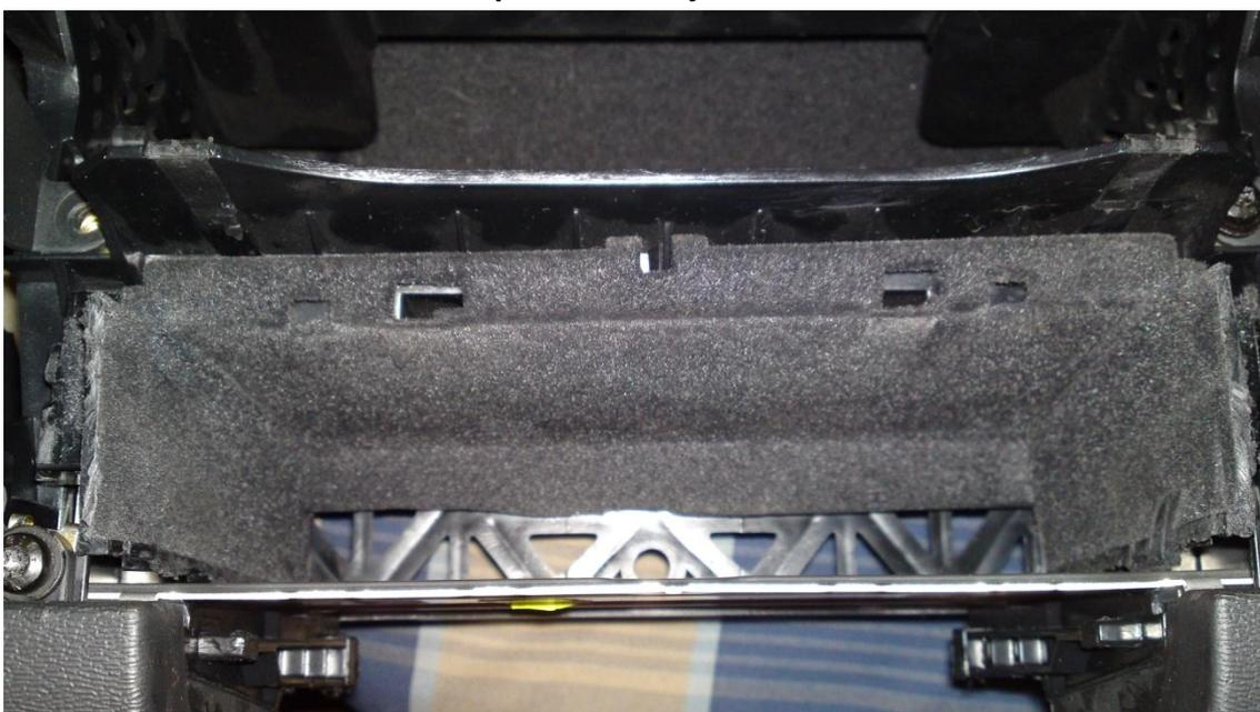
**En la foto, el soporte ya metido en su sitio y fijado con sus pestañas superiores y guías laterales.....**
