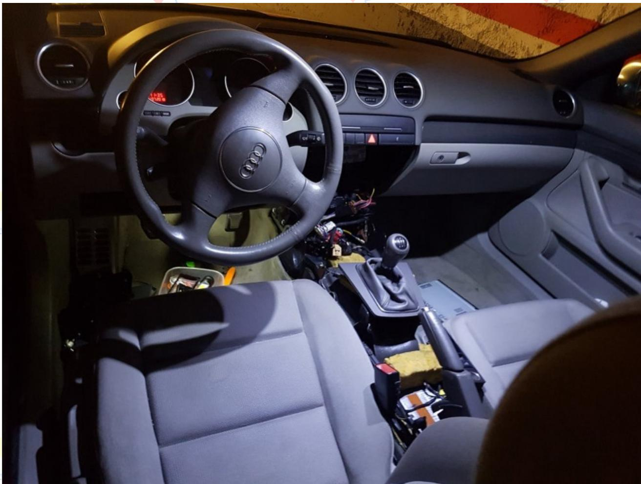
2- Ahora nos va a tocar trabajar con el mueble y la consola central para montar el mueble interior 2 din. Si compramos el mueble exterior específico, te ahorrarás hacer la adaptación, aunque básicamente es quitarle material porque toca el nuevo mueble. Marco en rojo las zonas que tocan con el mueble 2 din y que simplemente hay que rebajar hasta que encaje bien:
