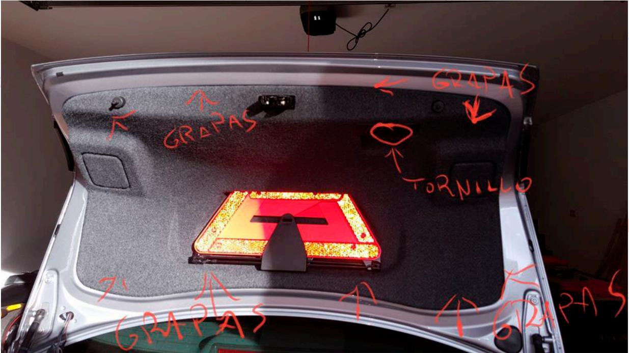
Quitar el tornillo y luego debemos retirar el triángulo y su sujeción.
