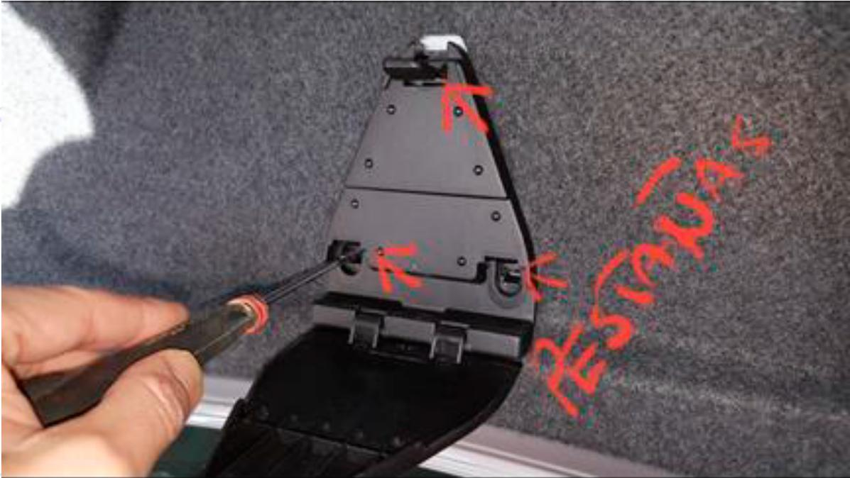
Seguimos ya con la cerradura a la vista y comprobamos que está sujeta al portón por dos tuercas y va unida a un conector eléctrico y a un cable de acero que acciona la apertura con llave de la cerradura.
