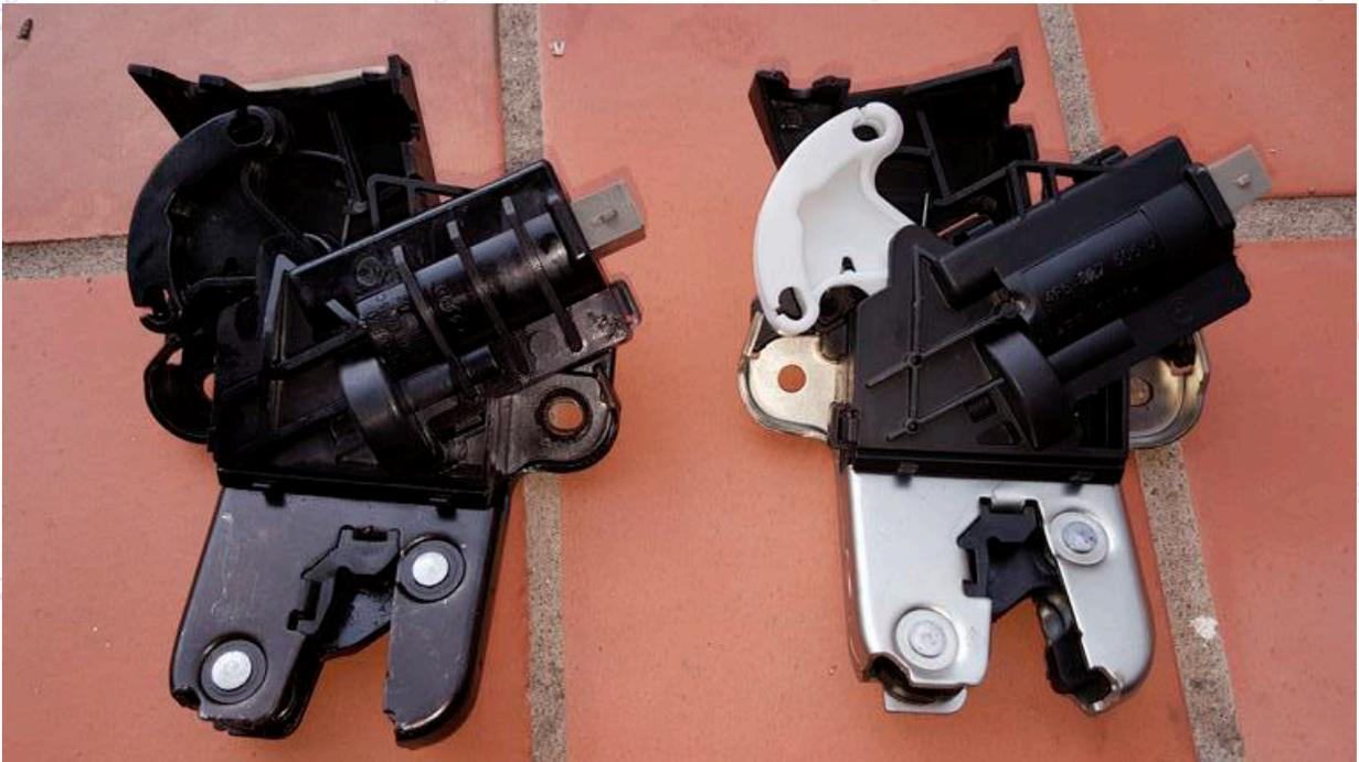
Para el montaje tomamos la cerradura nueva, que lleva un saliente para su correcta ubicación y apretamos las tuercas, seguidamente metemos el cable de acero de nuevo en el balancín y conectamos la electricidad.
