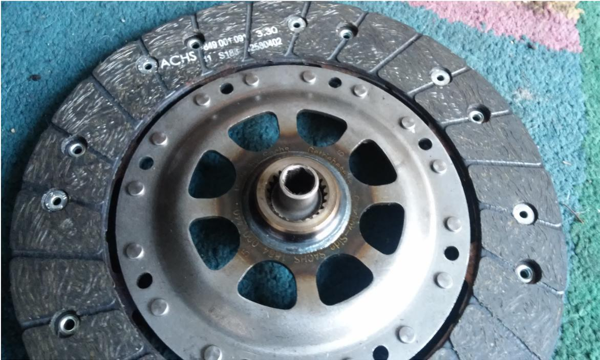
colocamos el disco pero hay que centrarlo... en mi caso suerte llave de 10 carraca grade diámetro exterior ancho exacto al interior del disco y el exterior de la parte fina 15mm exactamente el interior del hueco del bimasa, vamos un centrador clavado lo colocamos ponemos la maza la atornillamos de poco en poco y en cruz para que asiente bien y con el alargador de la carraca sacamos la llave de vaso de 10mm que usamos de centrador.
