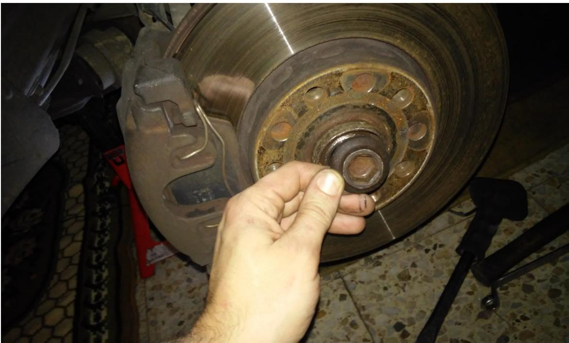
quitamos ese tornillo y después soltamos los 2 brazo superiores de la mangueta y también la rotula de dirección, para ello necesitamos llaves hexagonales de 13mm, y 16mm, quitamos los tres tornillos y sacamos las rotulas nos podemos ayudar apalancando un poquito la grieta de apriete con un destornillador plano grande.
