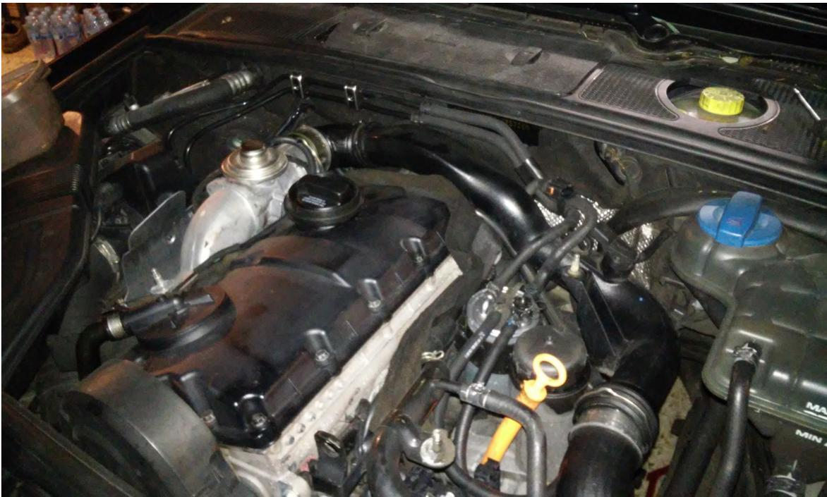
quitamos el manguito del turbo que va por detrás del motor; soltamos la clema del sensor, los
