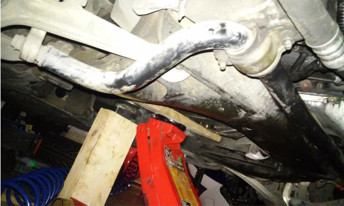
quitamos los 6 tornillos que aguantan el subchasis de la caja y sacamos la pieza y colocamos de esos 6 tornillos hexagonales de 18mm, los 2 mas largos que aguantan el semichasis del motor.
