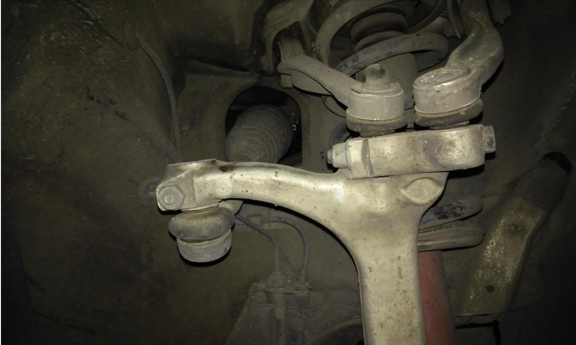
una vez suelto sacamos la junta homocinética y colocamos la rotula de dirección en la mangueta para que el latiguillo del freno no este tenso, con meterla es suficiente ahora para soltar la otra parte del palier nos hace falta un ayudante y una llave xzn M8 larga mejor, metemos punto muerto y vamos soltando tornillos y girando y el ayudante es necesario para frenar el coche mientras aflojas y soltar freno para girar y quitar el siguiente.
