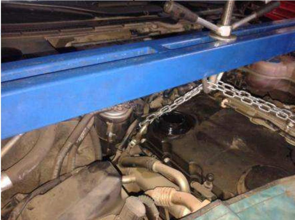
3º quitar taco frontal de motor, soltar barra estabilizadora, el puente y bajarlo y sostenerlo con un gato (al hacerlo en foso tiene la ventaja que puede dejar las ruedas en suelo)
