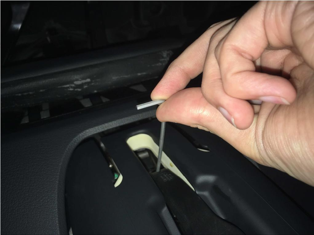
Llave torx 9 para los tornillos del guarnecido de la columna de dirección
