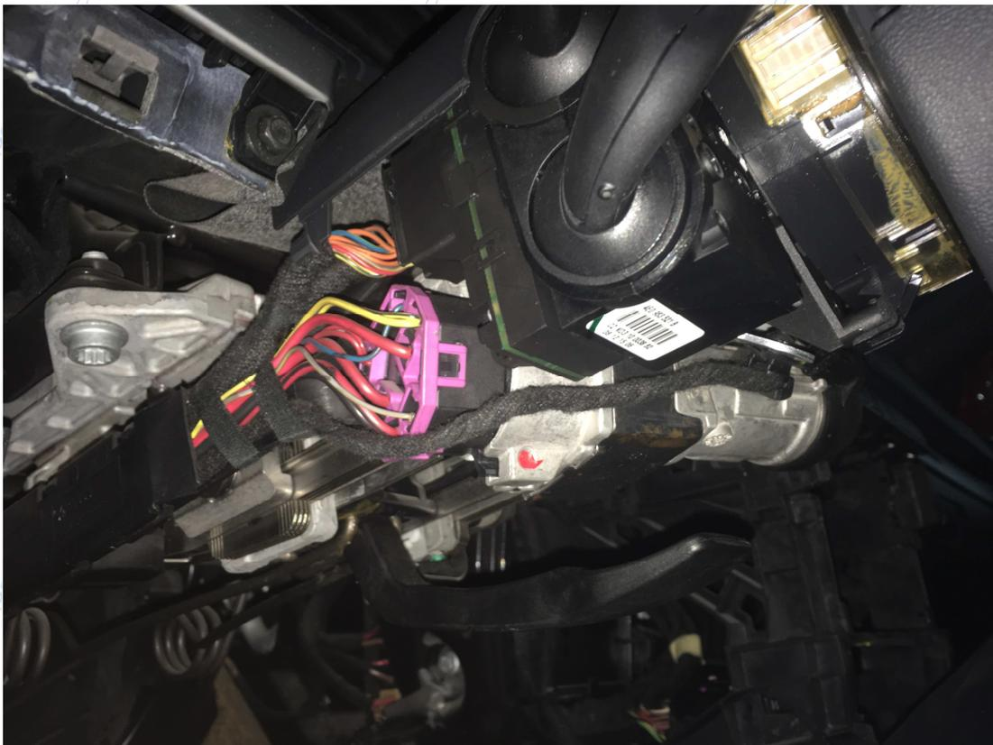
Para hacer la prueba, no anulé completamente la funcionalidad de arranque sino que soldé los cables junto a los terminales. Si se quieren anular, basta con sacar el pin 5 de su alojamiento.
