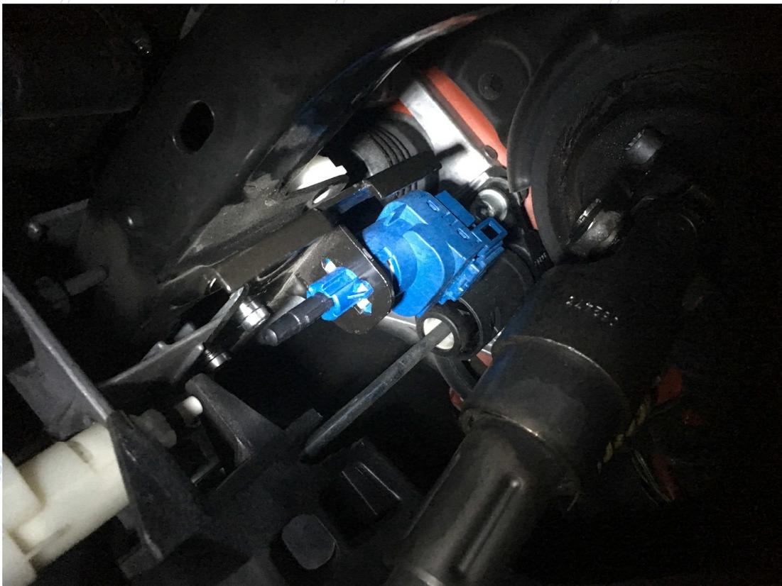
Seguimos localizando el conector del conmutador de arranque para hacer las conexiones en los pines:
