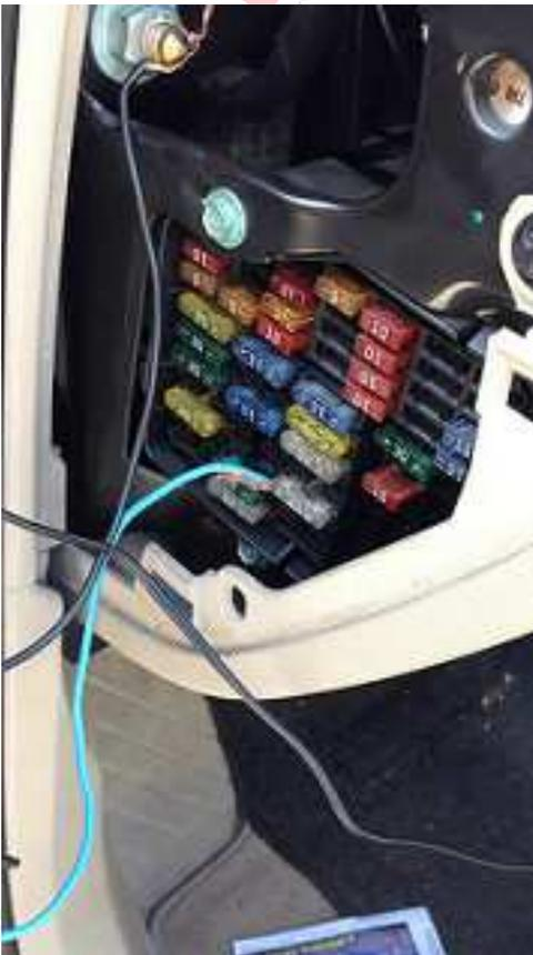
Yo en mi caso utilizare una salida de un fusible ,que al dar corriente en el contacto se enciendan , esto es muy fácil es solo ir probando a ver cual tiene corriente yo lo hice con uno de estos
