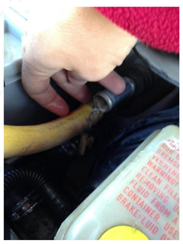
Proceso de limpieza finalizado. Ahora vamos con el llenado y purgado. Se vuelve a conectar el tubo de retorno al vaso de expansión y lo lleno con G12. o hya problema en asarse de la marca. Por lógica, ese nivel tiene que descender varias veces hasta "hacer el circuito" correctamente al completo.
