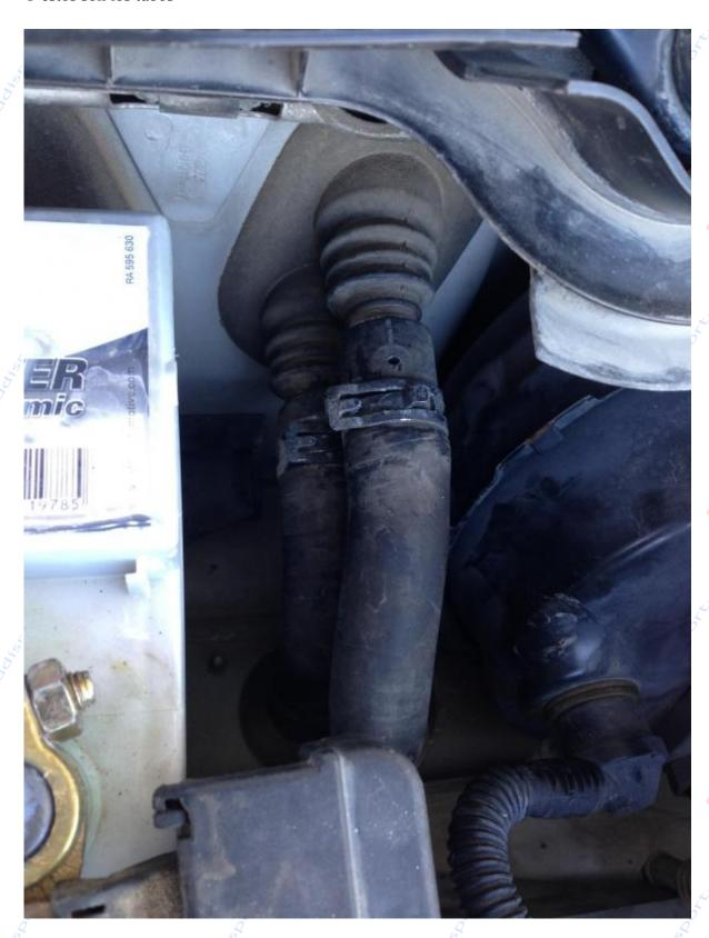
Para tener el "esquema" claro, el inferior es l de entrada del agua y, el superior, el de salida. Empezamos a quitar abrazaderas...
