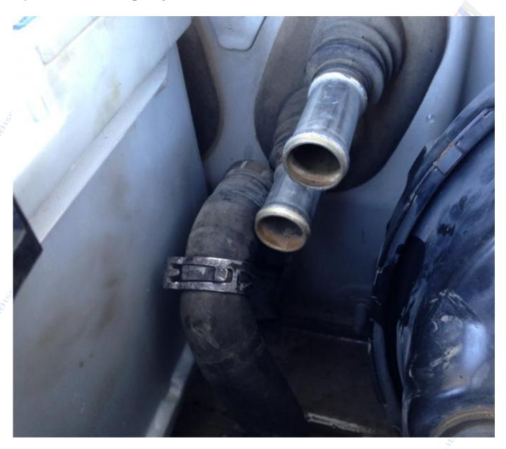
Y me voy a ayudar de un trozo de manguera que facilite la entrada de líquidos al radiador. He cortado un trozo y lo conecto tal que así
