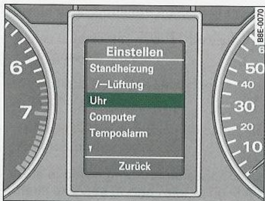
Fig. 37 Pantalla digital: Menú Einstellen (Ajustar), se ha seleccionado la opción Uhr (Reloj)
