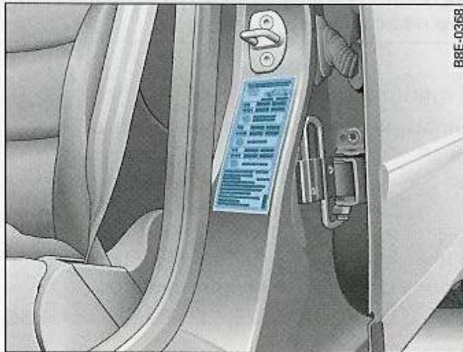
Fig. 237 Tabla con las presiones en el montante de la puerta
