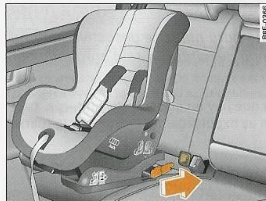
Fig. 204 El asiento para niños con sistema ISOFIX se encaja en las piezas de protección ya montadas
