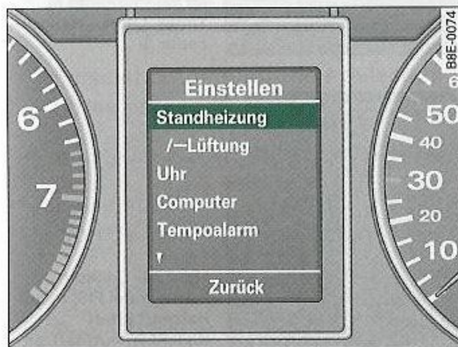
Fig. 131 Cockpit: Pantalla digital del FIS, menú Einstellen (Ajustes), se ha seleccionado Standheizung (Calefacción estacionaria)
