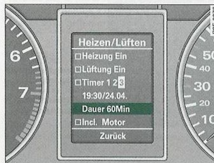
Fig. 134 Cockpit: Pantalla del FIS, menú Heizen/Lüften (Calentar/ventilar), se ha seleccionado la duración de funcionamiento del Timer 3 (Reloj temporizador 3)
