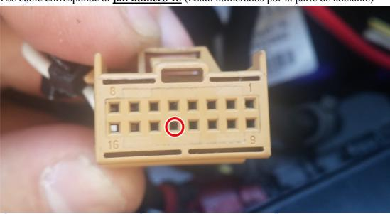
El cable que traíamos del <u>Fusible Aéreo</u> lo conectamos a ese pin y lo reforzamos para que no se mueva con una brida.
