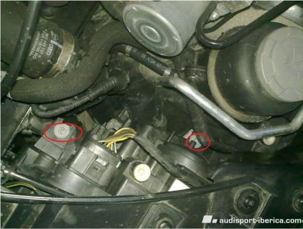
Después, con cinta carrocer se protegen las partes más susceptibles a rallarse, al extraer el faro.
