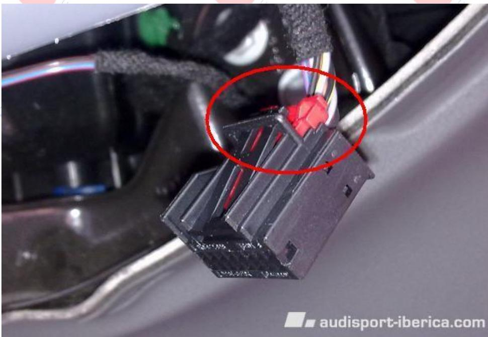
Para trabajar mejor realizando los empalmes, quitamos el protector del conector. Levantamos con un destornillador fino la pestaña y desplazamos hacia un lado.
