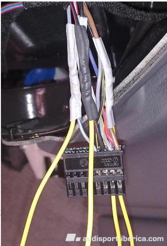
Aquí vemos los 4 cables empalmados con cable suficiente.
