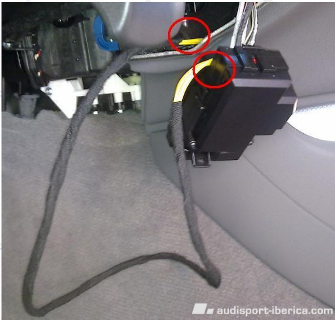
Evidentemente, antes de pasar los cables hacia la consola, esta se ha de desmontar y se han de desenchufar los conmutadores que tengamos. Por supuesto, tenemos que montar todo en la consola nueva.
