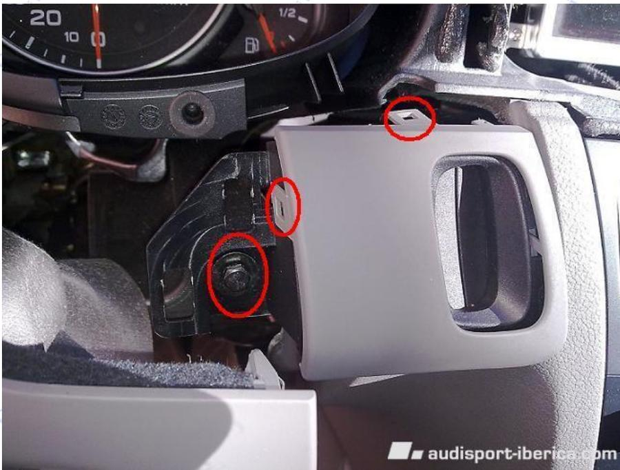
Quitar tornillo para que salga el interruptor de encendido-arranque. Sale muy fácil empujando hacia atrás y bajándolo por debajo del volante.
