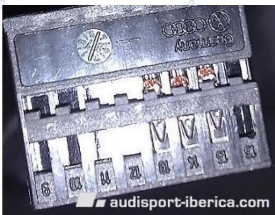
Para quitar los cables que necesitamos empalmar, con un destornillador fino presionamos donde la flecha y sacamos el cable hacia arriba. Iremos empalmado uno por uno, sacamos un cable, empalmamos y lo volvemos a meter donde estaba y así con los 4 cables. Se me olvidó comentar que el mazo de cables viene envuelto en cinta de vellón que tenemos que quitar para trabajar correctamente.
