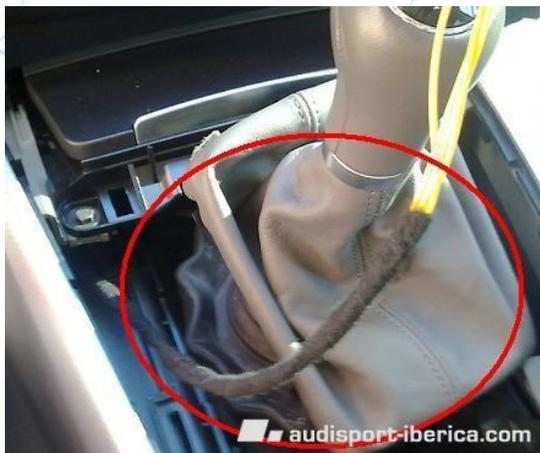
Aquí podéis ver como he llevado el interruptor encendido-arranque a su sitio con los cables empalmados y forrados. Para que no queden sueltos, los he unido con vellón a un mazo de cables que purula por ahí.
