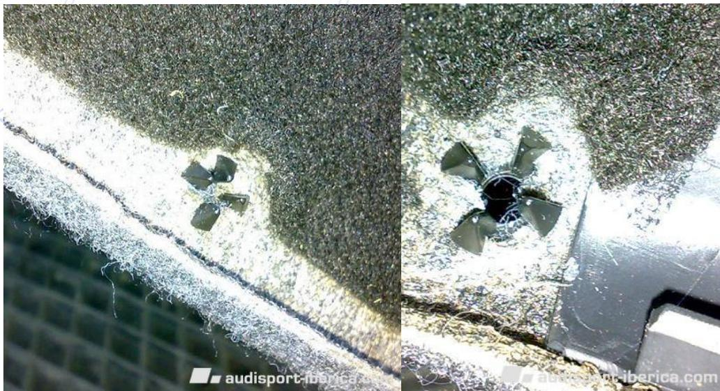
Anclando los ganchos que van a ras!!! Y como con un destornillador realice presión a los chirimbolos de metal para que queden bien fijos:
