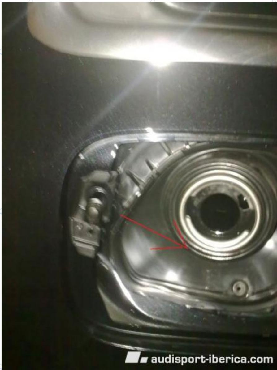
El motor sale tirando de él hacia la derecha cuidadosamente, se coge con la mano se quita el conector eléctrico, y se cambia y se pasa el cable rojo de seguridad (el cual es de plástico y está muy rígido) Se coge muy fácil por dentro del maletero y se engancha en el clip que lleva tal y como iba el original.
