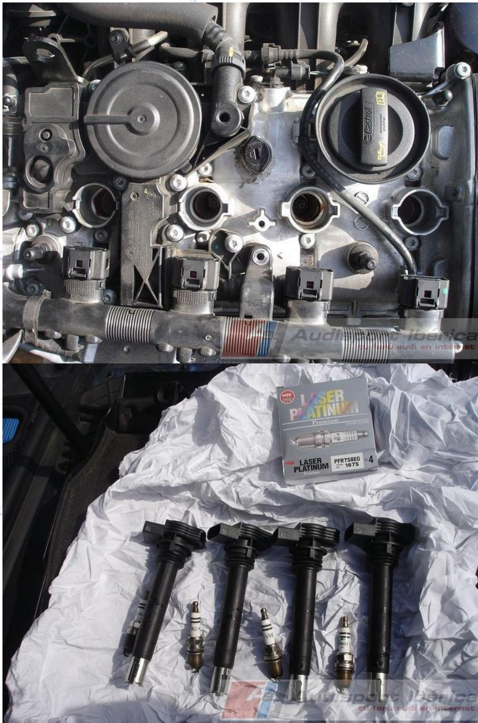
Montamos las 4 bujías nuevas siguiendo el orden establecido utilizando el alargador de 1/2 con la llave de vaso de bujías de 16 mm. y las roscamos a mano hasta que hagan tope en cada taladro roscado:
