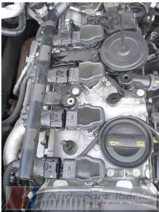
Acoplamos los conectores de las bobinas de encendido uno a uno hasta que queden perfectamente encajados, notaremos que hace un "click" cuando encajamos el conector en la bobina de encendido:
