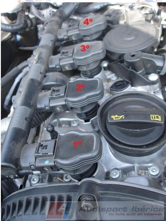
Desacoplamos los conectores de las bobinas de encendido tirando con el dedo hacia atrás de la pestaña que llevan y los vamos retirando de las bobinas:
