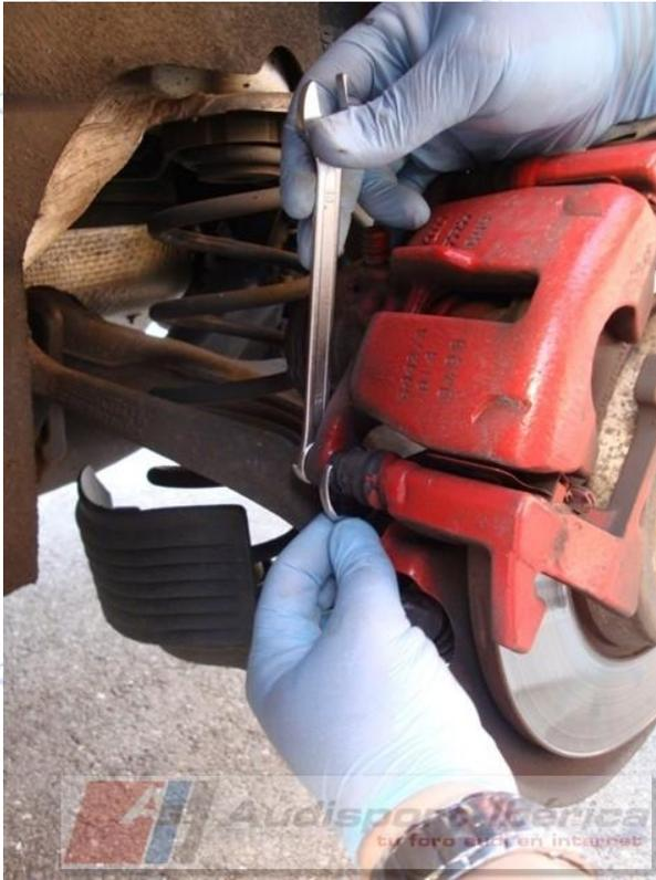
Retiramos las pastillas viejas y este es el aspecto del disco sin pastillas y con la pinza quitada, cuidado con la pinza, pues si la dejamos suelta puede dañar el disco y perder líquido de frenos
