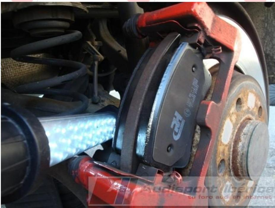
Ahora vamos a meter el pistón, el que no tenga reposicionador que lo haga con el gato de carpintero como lo hice con las delanteras, tenéis el brico en la sección de bricos.
