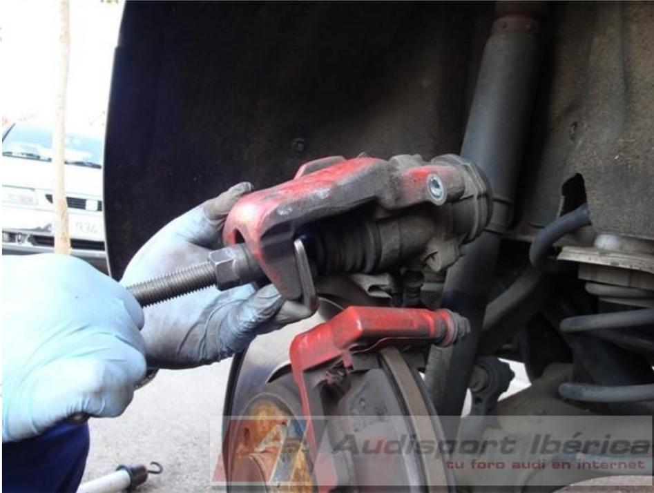
Y así queda el pistón metido para que podamos montar la pinza
