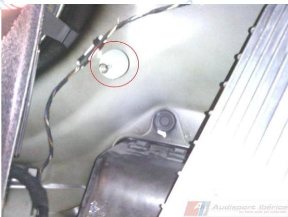
Esa tuerca sujeta el paragolpes a la carrocería, la desenroscamos de ambos lados y vamos con la siguiente:
