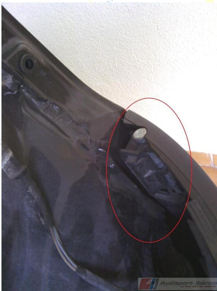
Tiramos hacia arriba y sacamos el perno liberando la conexión que hay entre el paragolpes y la sujeción de la chapa de la carrocería:
