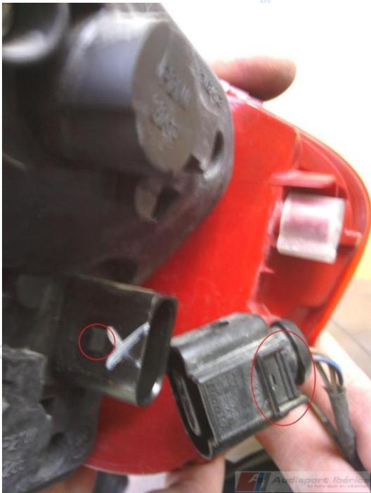
Desconectamos el conector de los faros pulsando la clema que vemos en la foto y depositamos los faros en un lugar donde no se dañen o se caigan. Realizamos este paso en ambos faros y nos quedaran los huecos de los faros descubiertos.
