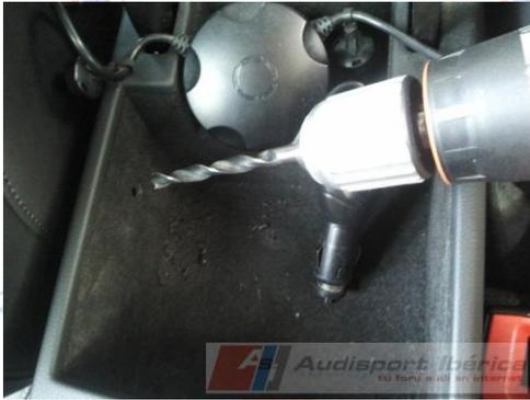
*Por el agujero pasaré los cables al interior de la consola para que no se vean, colocando el mando pegado a la pared del hueco con un velcro, el cual una vez puesto tapará el agujero del taladro y me permitirá cambiar fácilmente las pilas o de mando cuando lo necesite sin la necesidad de volver a desmontar nada.*
