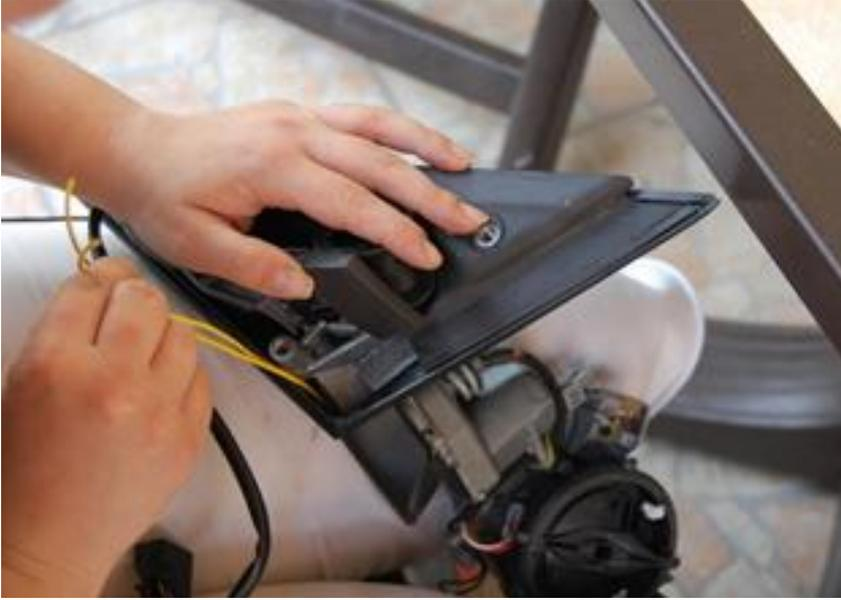
Ya esta pasado los dos cables, pues ahora toca precintar los cables con la cinta de tela para reforzar los cables y nos queda poner una nueva brida rodeando la manguera de cables mas los nuevos cables.
