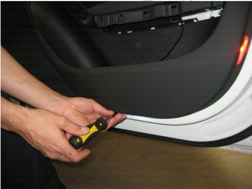
Pues ya toca quitar el panel de la puerta, para soltar el panel de la puerta hay que empezar desde abajo. La forma correcta de hacerlo sería utilizar una cuña de plástico y deslizar en cada clips y se liberaran. El primero para quitar seria en la parte inferior de la puerta cerca del borde de la puerta y darle un buen tirón.
