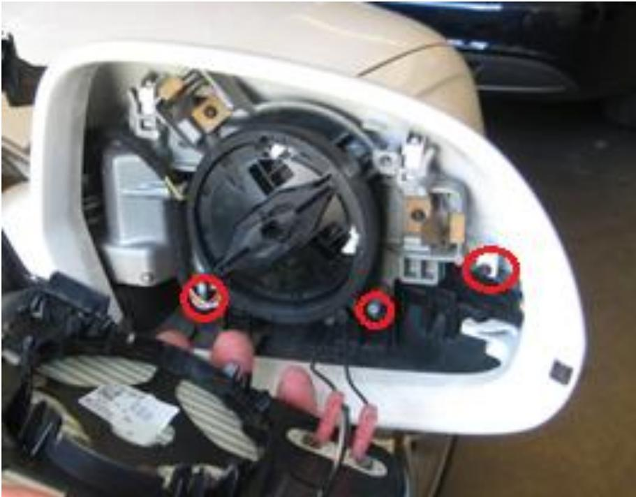
Ahora con un destornillador o con una herramienta de plástico presionar las 2 pestañas para poder sacar la carcasa, tire de la carcasa tirando suavemente hacia arriba y hacia afuera.
