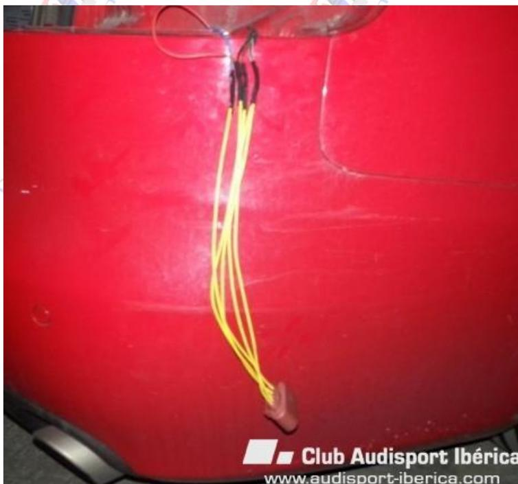
Ya solo queda montar los pilotos nuevos y conectar, el interior tiene truco, se tiene que encajar de lado y luego buscarle la posición al seguro que se atornilla y a conectar.
