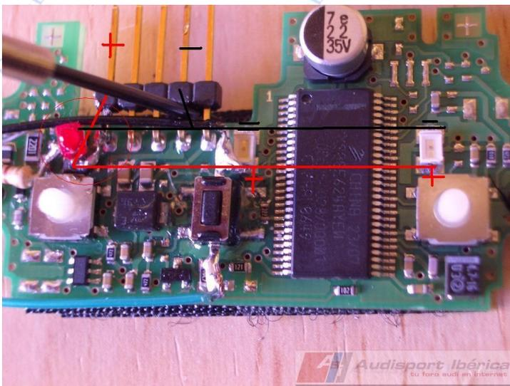
Bueno pues ya tenemos el mando funcionando y tan solo nos queda montarlo y conectar los testigos del HOMELINK a las luces de ambiente del coche para que luzcan con el contacto.
