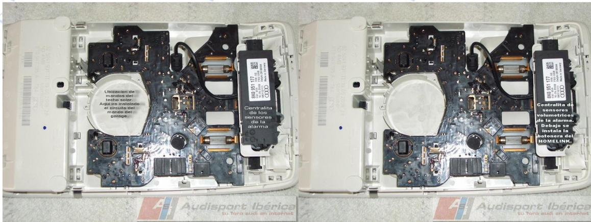
4º Desmontamos la centralita de los sensores volumétricos de la alarma (si no lleva alarma pues mejor algo menos que desmontar). Veremos debajo el lugar destinado a la botonera del homelink. Al plafón van principalmente dos grupos de cables:
