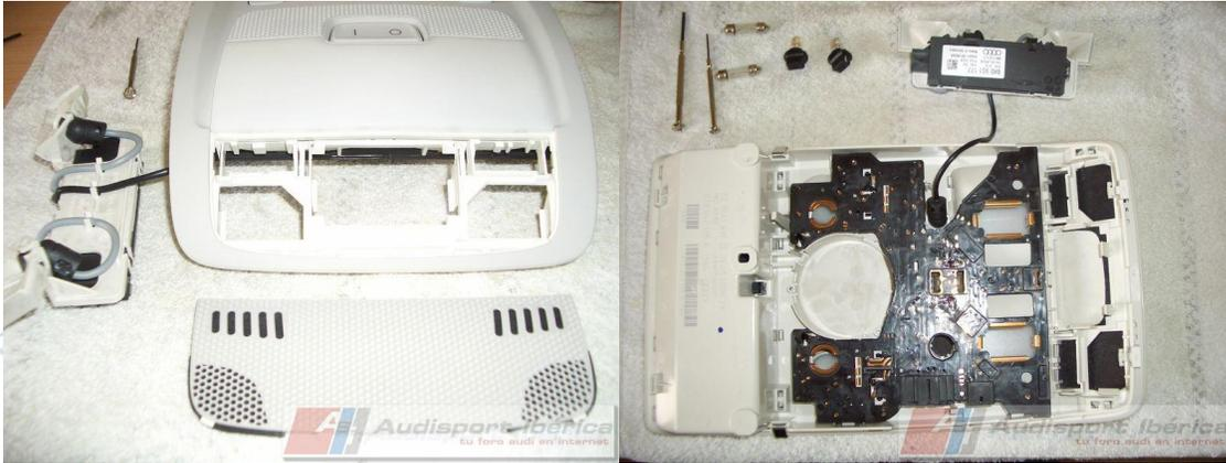
5º Desmontaje por la parte delantera del plástico del plafón, de una de los porta bombillas se tomara la corriente para iluminar los botones del homelink para que se enciendan los testigos cuando encendamos las luces.
