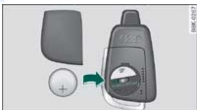
**Fig. 2** Cambio de la pila del control remoto
