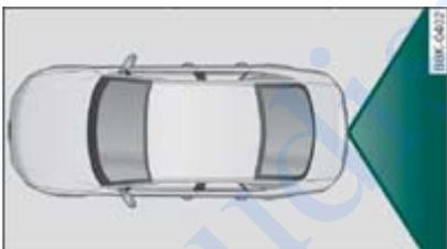
**Fig. 1** Vista desde arriba: Zona de detección de la cámara de marcha atrás
