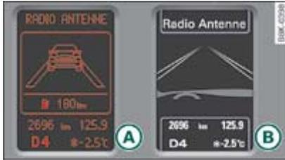
**Fig. 2** Cuadro de instrumentos: lane assist activado pero no operativo
