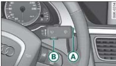
**Fig. 2** Palanca del limpiaparabrisas:
