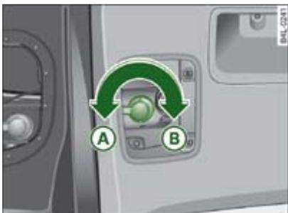
**Fig. 1** Esquema: Base portalámpara con cierre de bayoneta
