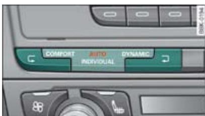
**Fig. 2** Consola central: Mando del Audi drive select
