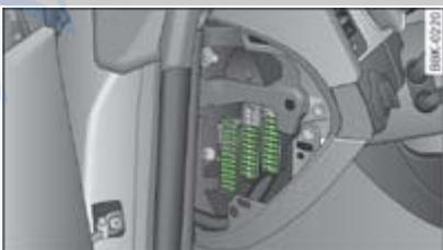
**Fig. 1** Ilustración básica del portafusibles (vehículos con volante a la izquierda)
