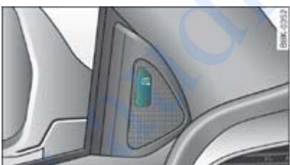
**Fig. 1** Puerta del conductor: Tecla del side assist
