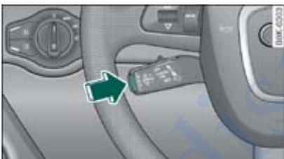
**Fig. 1** Palanca de mando: Memorizar la velocidad
