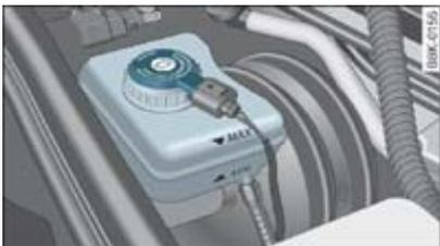
**Fig. 1** Compartimento del motor: Marcas en el depósito del líquido de frenos
