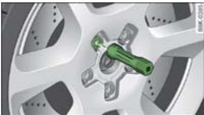
**Fig. 1** Cambio de rueda: Útil de hexágono interior para girar los tornillos
