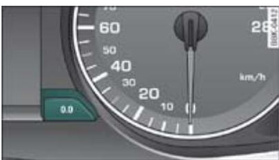
**Fig. 2** Cuadro de instrumentos: Tecla de puesta a cero
