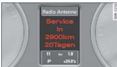
**Fig. 1** Pantalla del cuadro de instrumentos: Indicador de intervalos de servicio
