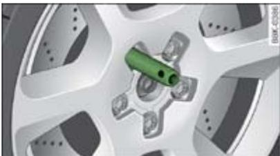
**Fig. 2** Cambio de rueda: Pasador de montaje en el agujero superior
