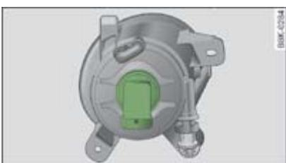
**Fig. 1** Faro antiniebla: Base portalámpara marcada
