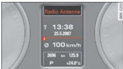
**Fig. 1** Pantalla: Información adicional de la radio
