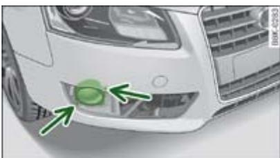
**Fig. 2** Tornillos de fijación del faro antiniebla
