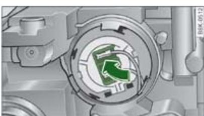
**Fig. 2** Colocar la lámpara de la luz de carretera
