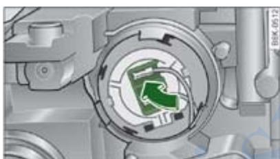
**Fig. 2** Colocar la lámpara de la luz de cruce
