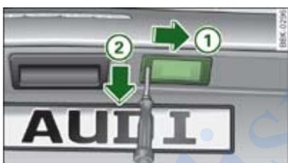
Fig. 1 Portón del maletero: Desmontar la luz de la matrícula
