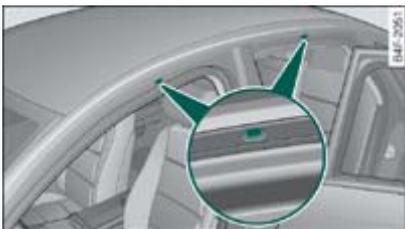
**Fig. 1** Puntos de fijación para soportes básicos
