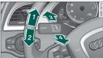
Fig. 1 Palanca de los intermitentes
