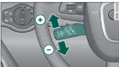
**Fig. 1** Palanca de mando: Modificar la velocidad
