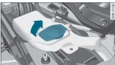
Fig. 1 Compartimento del motor: Depósito del lavacristales
