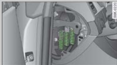
**Fig. 1** Ilustración básica del portafusibles (vehículos con volante a la izquierda)
