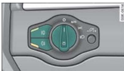
**Fig. 1** Tablero de instrumentos: Conmutador de las luces
