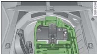
**Fig. 1** Maletero: Herramientas, tire mobility system y gato
