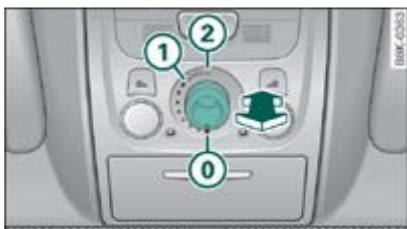
**Fig. 1** Detalle del revestimiento del techo: Mando giratorio para el techo corredizo / deflector
