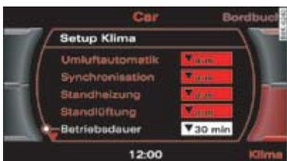
**Fig. 1** Pantalla: Funcionamiento (tiempo de funcionamiento)
