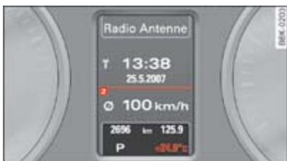
**Fig. 1** Pantalla: Indicador de temperatura exterior
