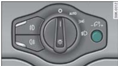
Fig. 1 Iluminación de los instrumentos
