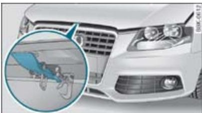
**Fig. 1** Tirador de apertura por debajo del capó
