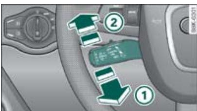
**Fig. 1** Palanca de mando: Activar y desactivar el sistema
