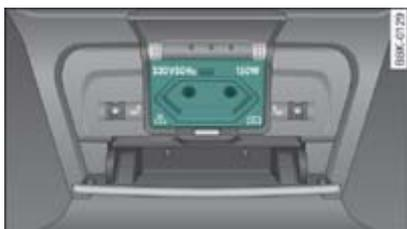
**Fig. 3** Consola central trasera: Toma de corriente tipo europeo de 230 voltios
