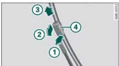
Fig. 2 Desmontar las escobillas del limpiaparabrisas
