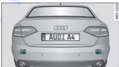
**Fig. 1** Parachoques trasero: Posición de los sensor de radar (no se ven desde el exterior)
