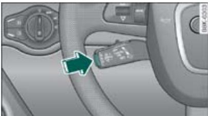
**Fig. 2** Palanca de mando: Memorizar la velocidad
