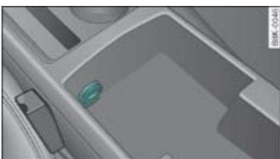
**Fig. 2** Toma de corriente en la consola central
