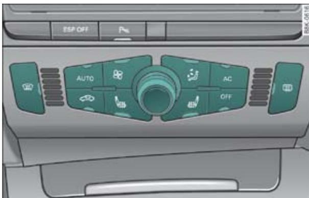
**Fig. 1** Mandos del climatizador automático de confort
