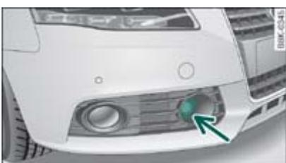
**Fig. 2** Rejilla delantera derecha: Posición del sensor de radar
