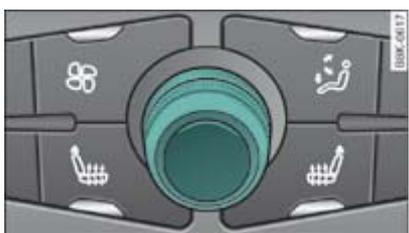
**Fig. 1** Regulador para el ajuste de la temperatura
