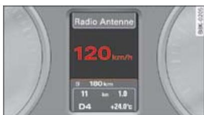
**Fig. 1** Pantalla: Velocímetro digital
