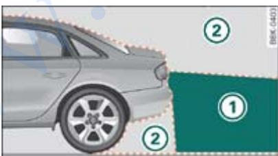
**Fig. 2** Vista lateral: Zona de detección -1- y zona no detectada -2- de la cámara de marcha atrás.
