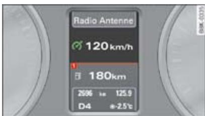
Fig. 2 Pantalla: Velocidad seleccionada
