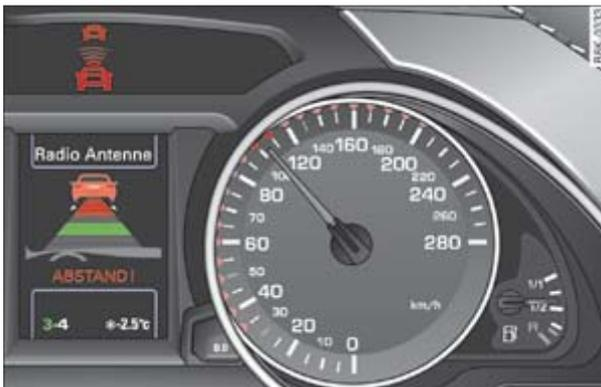
**Fig. 1** Cuadro de instrumentos: Solicitud de intervención del conductor
