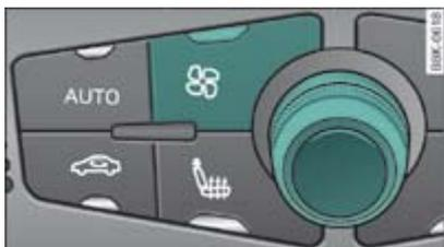
**Fig. 1** Tecla de ventilación y regulador
