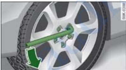
**Fig. 1** Cambio de rueda: Aflojar los tornillos
