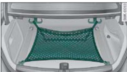
**Fig. 2** Red para equipaje enganchada
