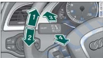
Fig. 1 Palanca de los intermitentes
