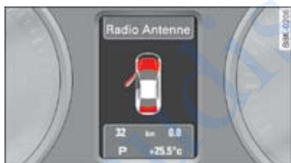
**Fig. 1** Pantalla: Aviso sobre las puertas y el portón del maletero
