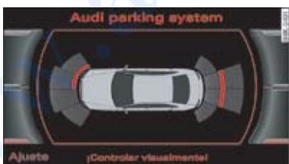
**Fig. 2** Pantalla: Indicación óptica de la distancia
