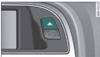
**Fig. 1** Puesto de conducción: Interruptor para intermitentes simultáneos de emergencia
