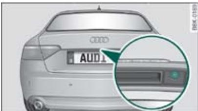
**Fig. 1** Portón del maletero: Lugar de montaje de la cámara de marcha atrás
