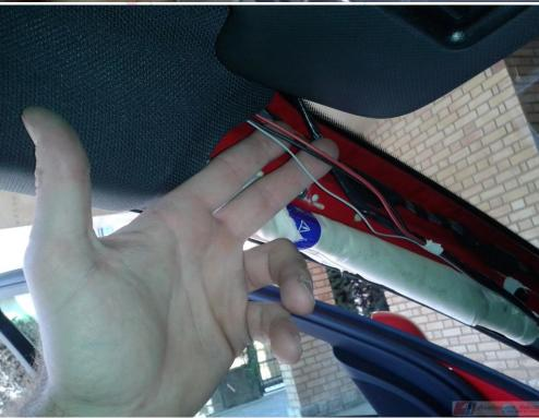
Una vez tenemos los cables donde el sensor los conectamos con los trozos de cables que compramos en el conce
