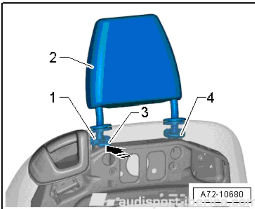
\*Si la tecla de desbloqueo no se deja desbloquear en la forma descrita se tiene que desmontar el protector del respaldo. Introducir la mano debajo del protector del respaldo y buscar el punto de resistencia de la tecla de desbloqueo.
