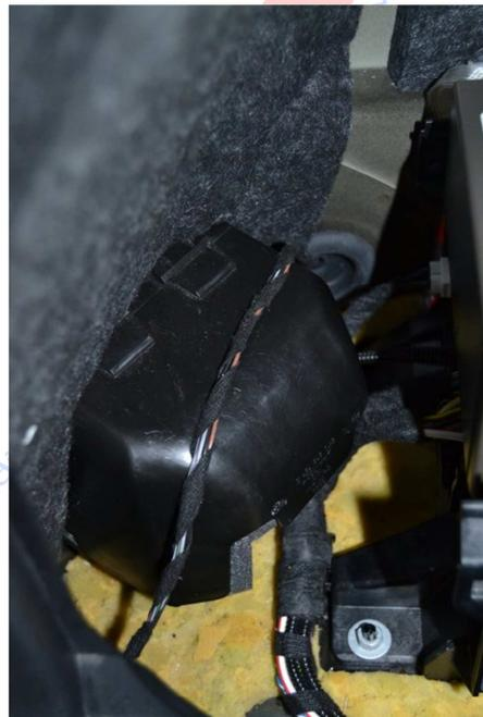
Sabiendo esto, ya podemos cortar el cable, (verde en este caso) y procedemos a conectar con los cables de nuestro módulo. El trozo cortado que viene desde delante es el que conectaremos con el cable marcado con el anillo rojo.
