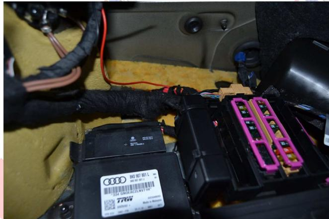
He aprovechado la batería de fusibles para sujetar el módulo con un par de bridas. Así la tengo accesible y fija sin más problemas.
