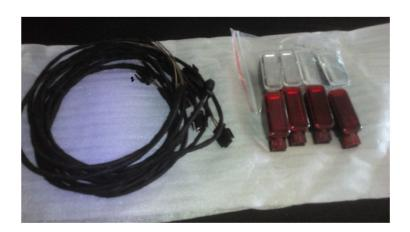
Por su parte, el cableado ya viene listo para cada conjunto de puerta. El cable que corresponde a positivo va pineado en su extremo, y el negativo no.
