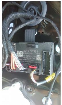
El conector que hemos desenchufado queda en los cables que van en el panel. Ahí es donde realizaremos las conexiones.
