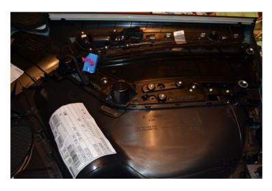
El conector delantero es fácil de abrir. Con un pequeño destornillador plano lo desmontamos en segundos:
