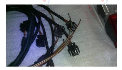
El conector que hemos desenchufado de la centralita de la puerta queda en los cables que van en el panel. Ahí es donde realizaremos las conexiones.
