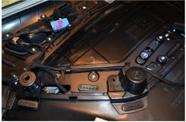
Ya tendríamos el primer panel terminado (eléctricamente hablando). Nos queda realizar el agujero de la parte inferior del panel donde irá alojado el plafón que ilumina hacia el suelo. El agujero de la parte lateral ya viene hecho, pero en él viene un reflectante de color rojo que sustituimos por un plafón rojo con bombilla de nuestro kit.
