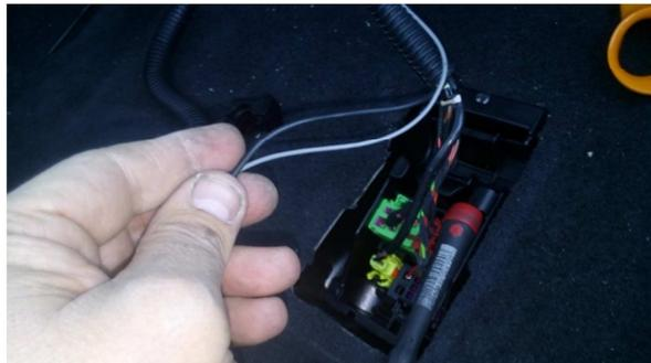
El cable negativo del plafón lo soldamos al cable negativo del conector rojo.
