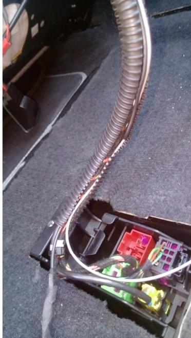
El siguiente paso es llevar este cable positivo hasta la J519. Empezamos pasándolo por debajo de la moqueta hasta la canaleta de la puerta.
