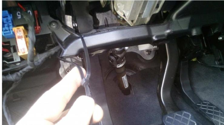
Sujetos los cables y encintados con cinta de fieltro, sólo queda conectar y codificar con Vag-com, para que nuestro coche sepa que tiene las luces instaladas...Ya podemos montar guantera y tapa bajo volante y conectar el PC.
