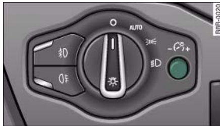
Fig. 46 Iluminación de los instrumentos
