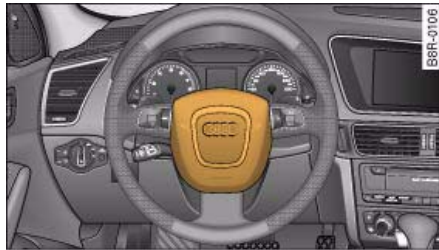
Fig. 179 Airbag del conductor en el volante
