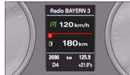
Fig. 107 Pantalla: Velocidad seleccionada
