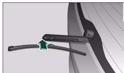
Fig. 54 Limpialuneta: Desmontar la escobilla
