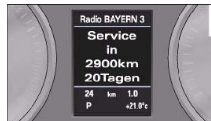
Fig. 11 Pantalla del cuadro de instrumentos: Indicador de intervalos de servicio
