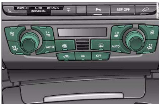
Fig. 97 Climatizador automático de confort de 3 zonas*: Mandos
