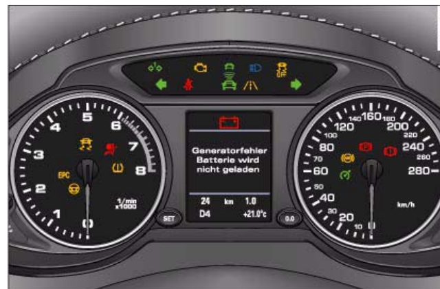
Fig. 7 Cuadro de instrumentos: Testigos de control
