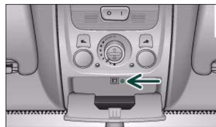
Fig. 36 Detalle del revestimiento del techo: Desenroscar la unidad de iluminación
