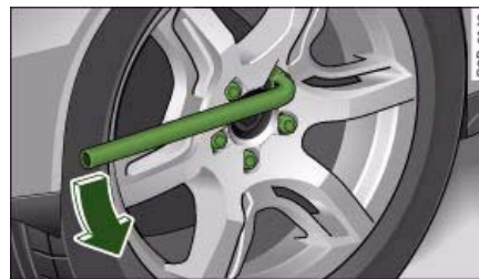
Fig. 231 Cambio de rueda: Aflojar los tornillos
