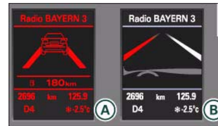
Fig. 130 Cuadro de instrumentos: lane assist activado y operativo
