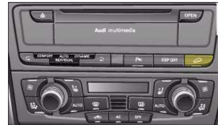
Fig. 196 Consola central: Tecla para el sistema de descenso asistido
