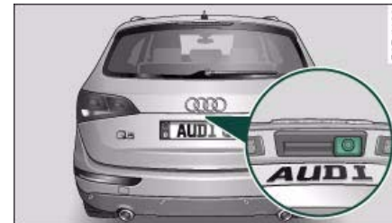
Fig. 157 Portón del maletero: Lugar de montaje de la cámara de marcha atrás
