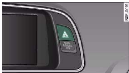
Fig. 43 Puesto de conducción: Interruptor para intermitentes simultáneos de emergencia
