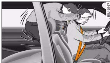
Fig. 172 El ocupante del asiento trasero que no lleve el cinturón de seguridad abrochado se verá lanzado hacia adelante.
