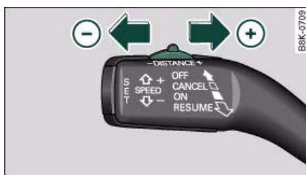
Fig. 114 Palanca de mando: Ajustar la distancia
