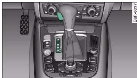
Fig. 146 Detalle de la consola central: Palanca selectora con tecla de bloqueo
