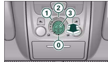
Fig. 35 Detalle del revestimiento del techo: Mando giratorio para el techo panorámico de cristal
