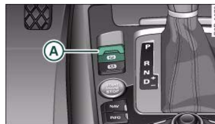
Fig. 103 Consola central: Freno de estacionamiento
