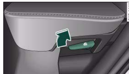
Fig. 85 Palanca de desbloqueo del respaldo del asiento lateral
