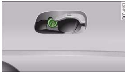
Fig. 264 Tornillo de fijación
