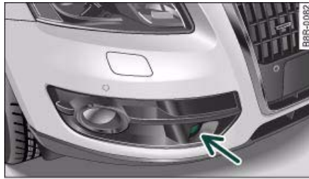
Fig. 108 Rejilla delantera derecha: Posición del sensor radárico
