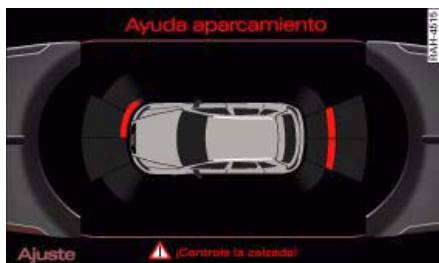
Fig. 153 Pantalla: Indicación óptica de la distancia
