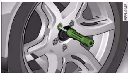
Fig. 234 Cambio de rueda: Útil de hexágono interior para girar los tornillos
