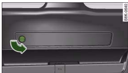
Fig. 220 Triángulo de emergencia en el portón del maletero
