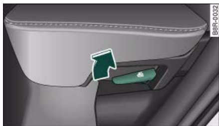
Fig. 61 Ajustar la inclinación del respaldo
