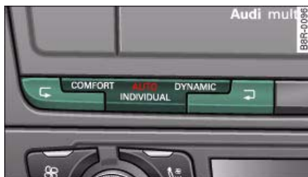
Fig. 143 Consola central: Mando del Audi drive select
