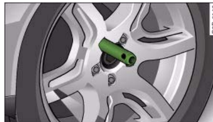
Fig. 235 Cambio de rueda: Pasador de montaje en el agujero superior
