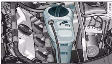
Fig. 212 Compartimento del motor: Marcas en el depósito de expansión del líquido refrigerante
