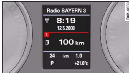
Fig. 8 Sistema de información para el conductor en el cuadro de instrumentos
