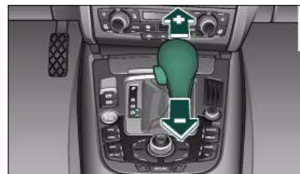
Fig. 147 Consola central: Cambiar las marchas manualmente (tiptronic)
