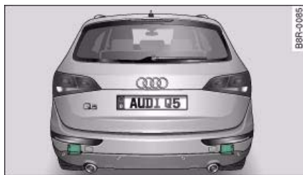
Fig. 132 Parachoques trasero: posición de los sensores radáricos (no se ven desde el exterior)
