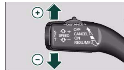
Fig. 112 Palanca de mando: Modificar la velocidad
