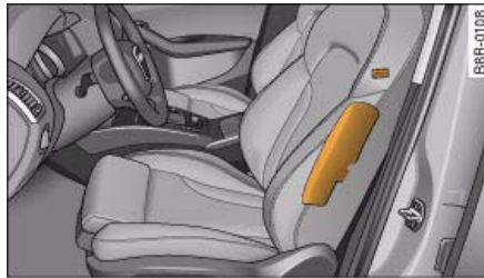
Fig. 183 Lugar de montaje del airbag lateral en el asiento del conductor
