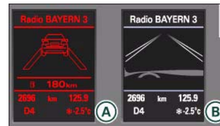
Fig. 131 Cuadro de instrumentos: lane assist activado, pero no operativo
