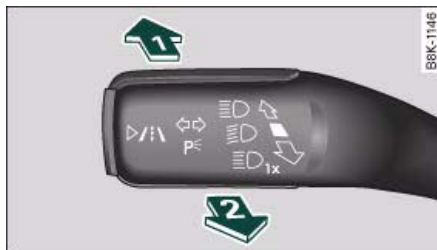
Fig. 41 Palanca de los intermitentes y de la luz de carretera: Activar y desactivar el sistema de asistencia para la luz de carretera
