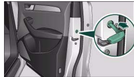
Fig. 28 Puerta: Bloqueo de emergencia
