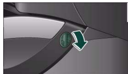
Fig. 77 Espacio reposapiés del acompañante: Punto de fijación multiusos
