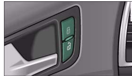
Fig. 26 Puerta del conductor: Interruptor del cierre centralizado
