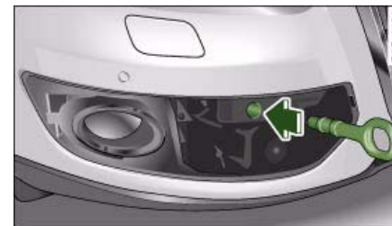
Fig. 240 Parte delantera derecha sin cubierta: Enroscar la argolla de remolque
