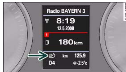
Fig. 42 Pantalla: Testigo del sistema de asistencia para luz de carretera
