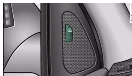
Fig. 134 Puerta del conductor: Tecla del side assist
